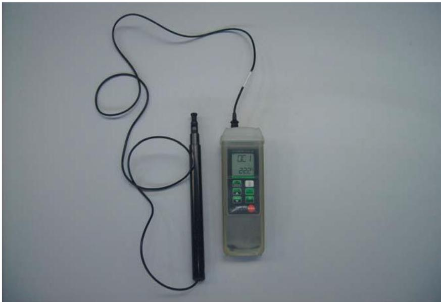
Figura 5.2. Anemómetro de hilo caliente.
