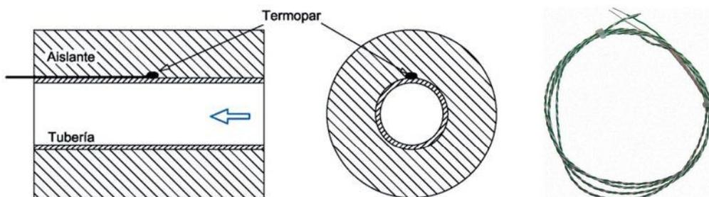
**Figura 2.9.** Montaje de termopares de pequeño tamaño en tuberías.
