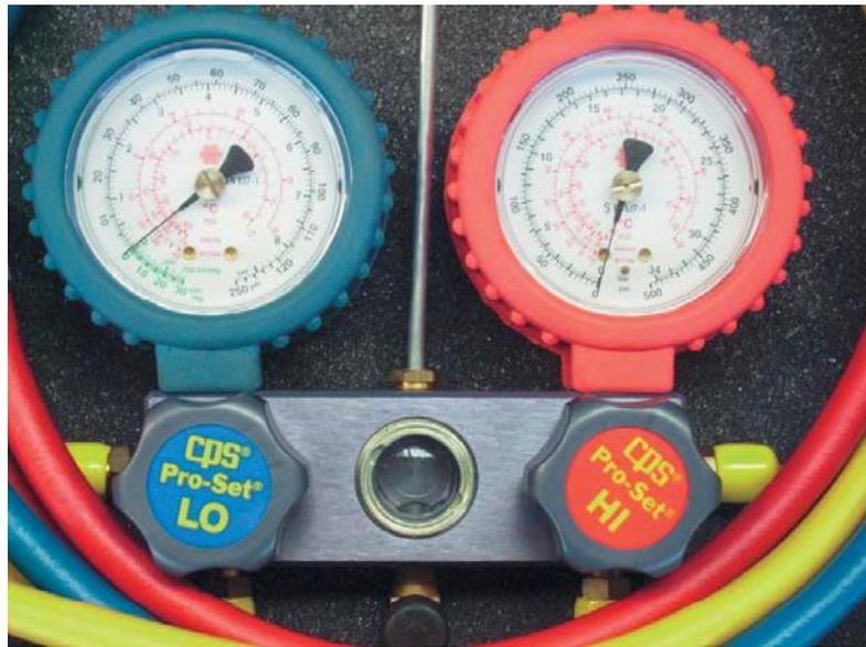
**Figura 3.2.** Manómetros mecánicos. Punteo de manómetros para la medida de las presiones de alta y baja en máquinas frigoríficas.
