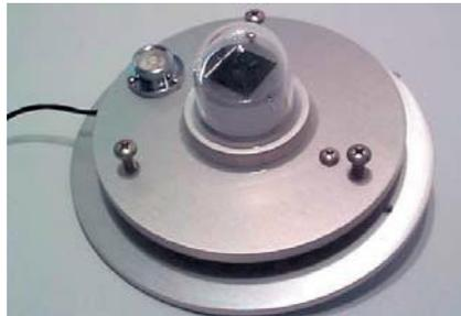
**Figura 6.13.** Piranómetros de célula de silicio de baja precisión.
