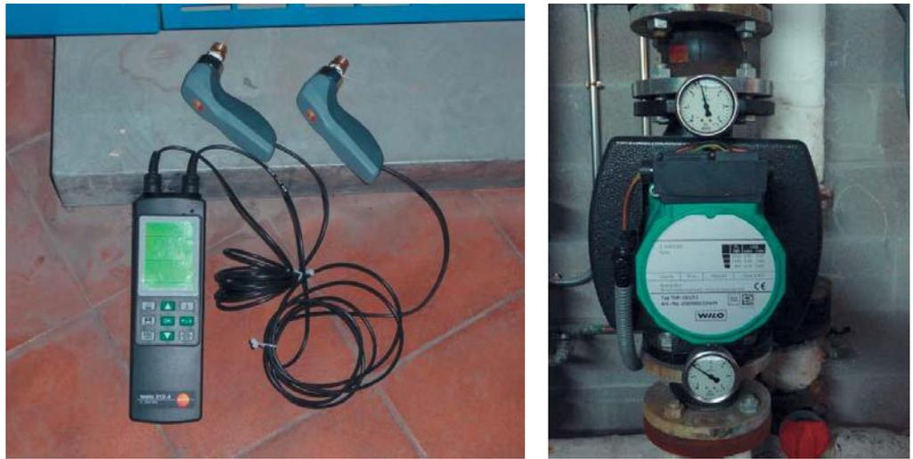
**Figura 4.7.** Manómetros para medida en bombas.
