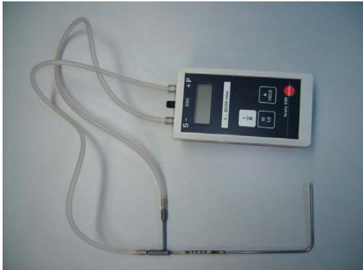
**Figura 5.4.** Anemómetro de tubo de pitot con micromanómetro.
