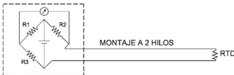
**Figura 2.5.** Conexión de RTD a 2 hilos.
