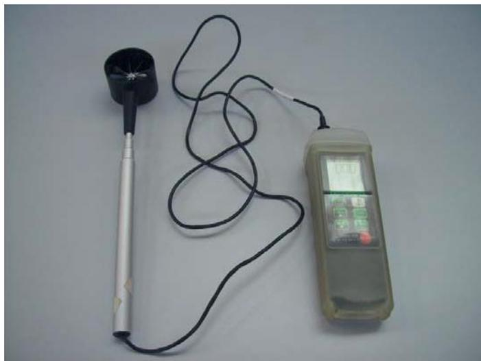
Figura 5.1. Anemómetro mecánico de turbina o de molinete.
