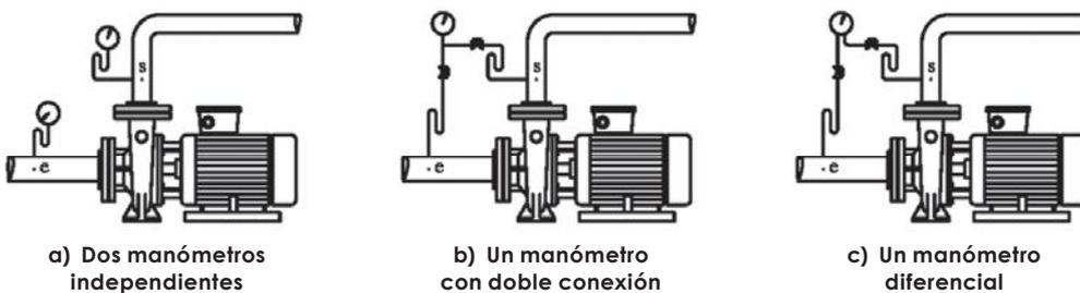
**Figura 4.6.** Medida del incremento de presión proporcionado por una bomba: mediante dos manómetros independientes, mediante un manómetro con doble conexión y mediante manómetro de presión diferencial.
