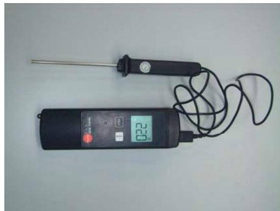
**Figura 2.10.** Termopar de contacto.
