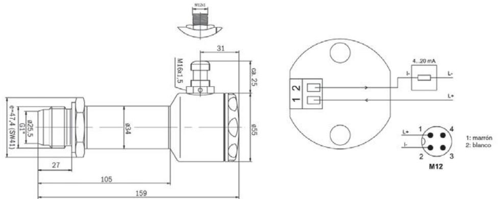
**Figura 3.4.** Transductor de presión comercial. Conexiones del transductor.
