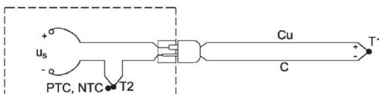
Figura 2.3. Lectura de temperatura mediante instrumento comercial.
