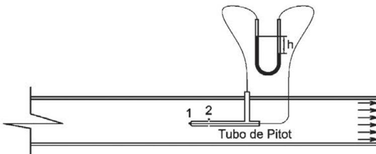
Figura 5.3. Principio de funcionamiento del tubo de pitot.
