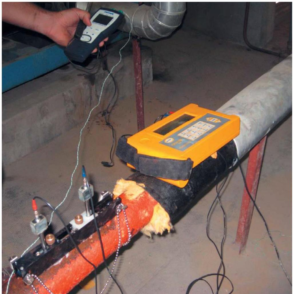
**Figura 7.11.** Medida de la energía térmica útil proporcionada por una enfriadora al circuito hidráulico.
