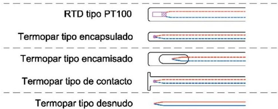
**Figura 2.6.** Configuraciones típicas de sondas de temperatura.
