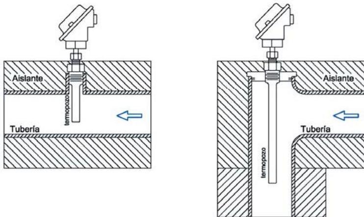
**Figura 2.8.** Montaje de sondas de temperatura en termopozos.
