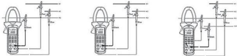
Figura 7.4. Conexión del medidor de potencia de 1 fase.
