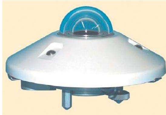
Figura 6.12. Piranómetro de precisión.
