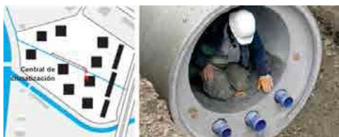
Figura 30. Mapa de la zona: en Línea azul principal de agua residuales, en rojo, bypass con el intercambiador calor Sala de calderas. Fuente: ENERES/KASAG.
