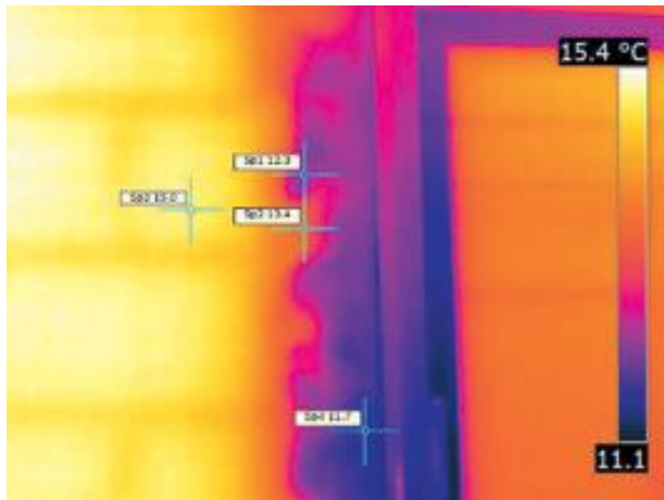
Imagen 3. La capilaridad del agua hace que esta tenga un patrón característico. La huella térmica del agua es casi siempre difusa y muy diferenciable de la de la infiltración de aire, más rectilínea.
