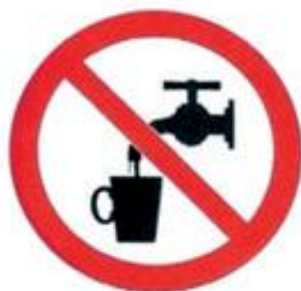
Figura 6. Ejemplo de señalización correcta en equipos y puntos de consumo conectados a redes de aguas grises.
