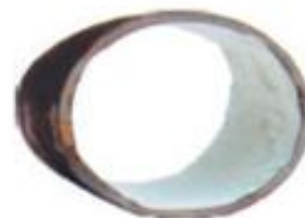
3.- Aplicación de la capa de Epoxi
