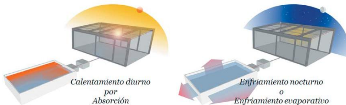
Figura 6. Comportamiento del vidrio activo conectado a una piscina.
