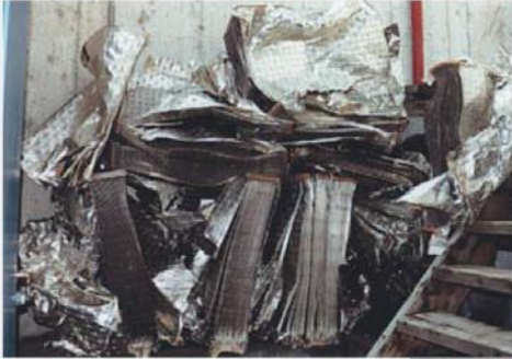
Cambio térmico del aluminio dañado por la corrosión
