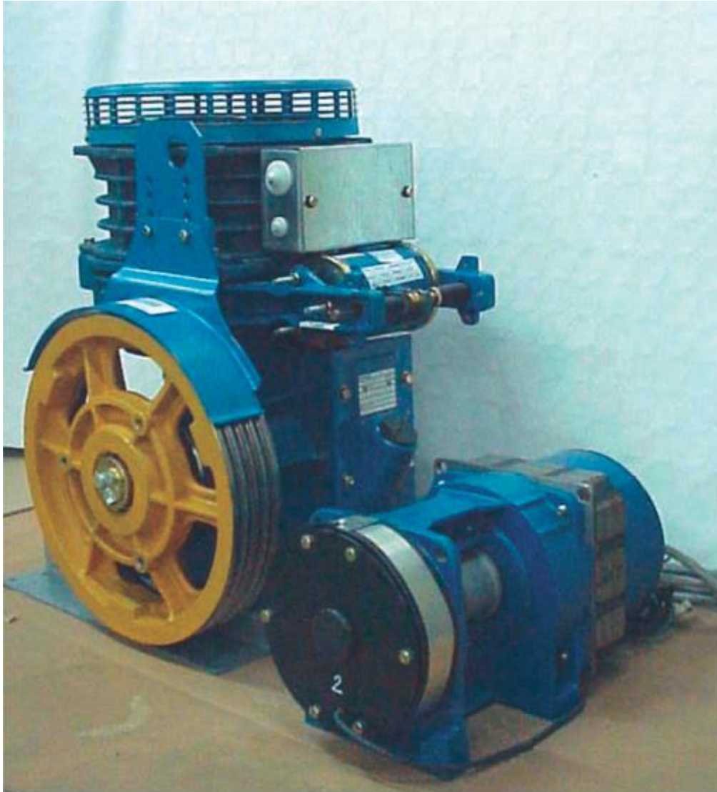
Máquina tradicional (con reductor de engranajes) Tracción por cable de acero
