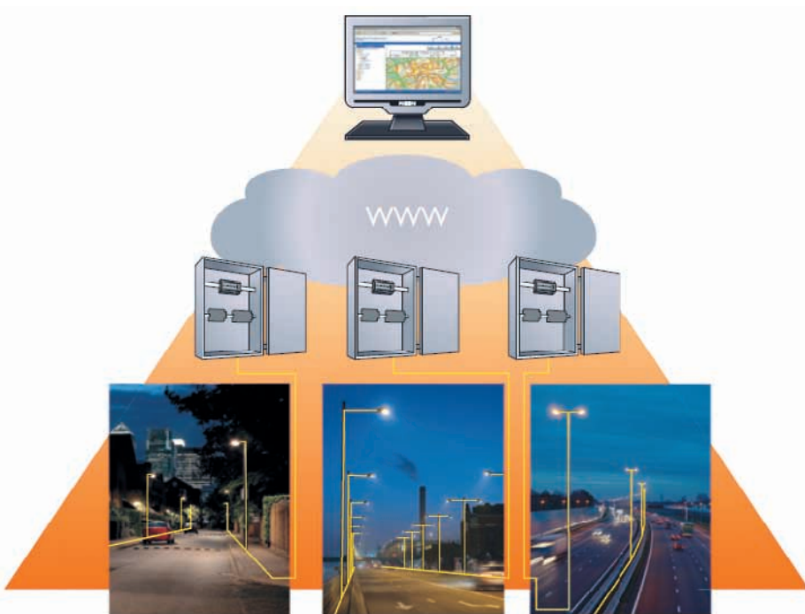
Figura 8. Sistema de telegestión punto a punto Starsense
