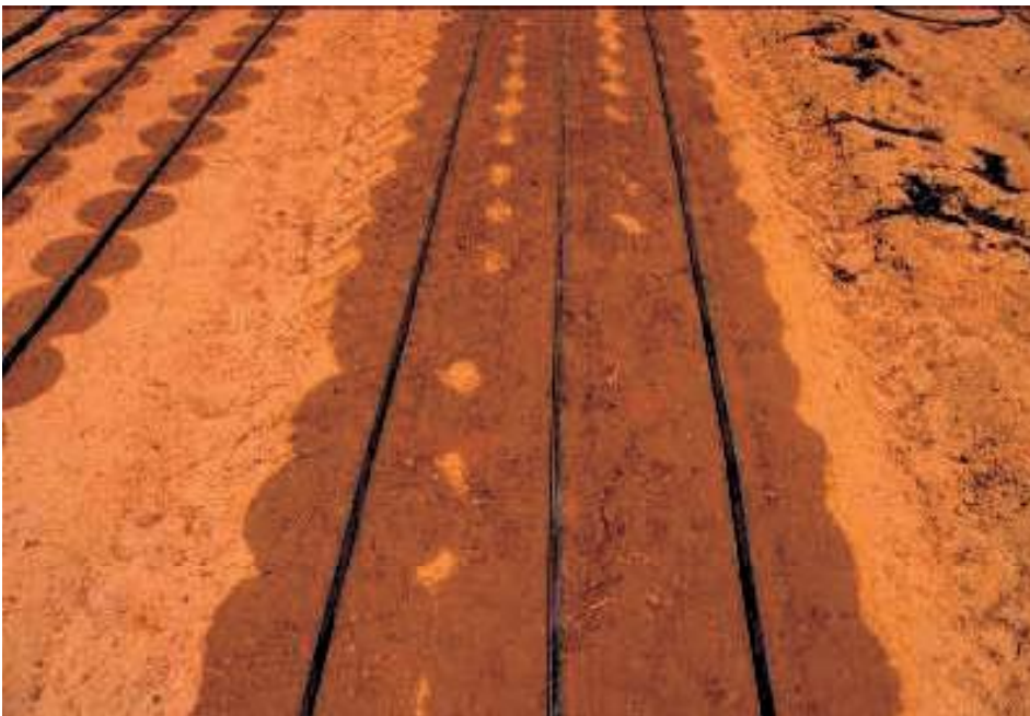
Foto 1. Ensayo goteros de ultra bajo caudal (0,6 l/h) frente a otros goteros (2,3 l/h). Fuente: Regaber
