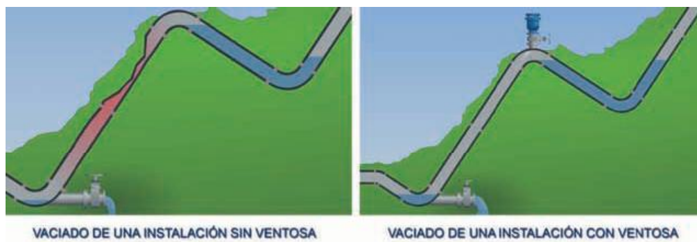
Figura 8. Problemas de depresiones durante el vaciado. Fuente: A.R.I.
