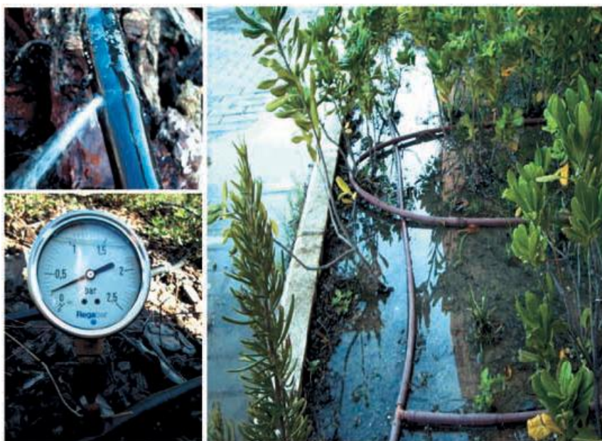
Foto 2. Comportamiento de un gotero por debajo del rango de autocompensación. Fuente: Regaber
