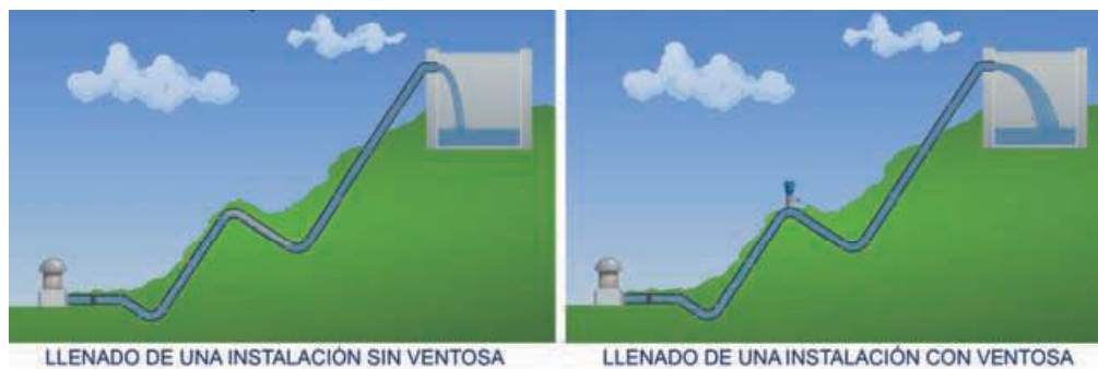
Figura 7. Problemas de pérdida de caudal durante el llenado. Fuente: A.R.I.
