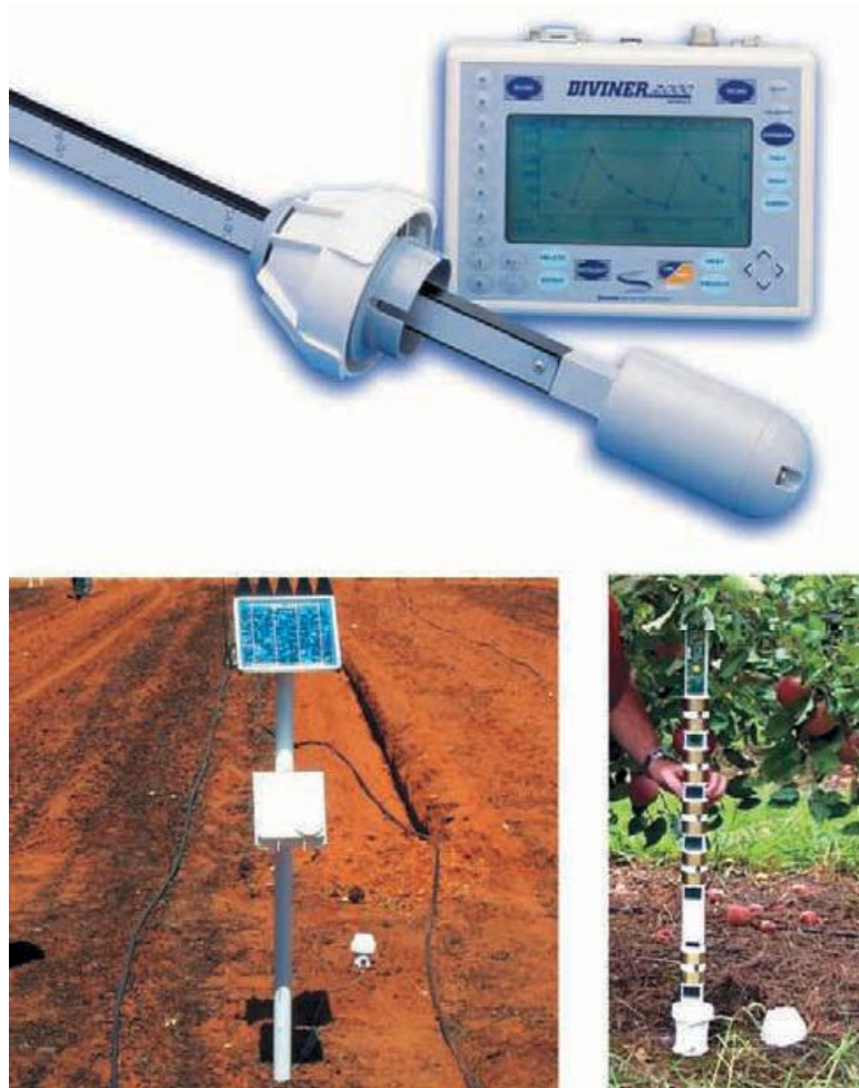
Figura 5. Sensores de humedad manuales y de lectura continúa. Fuente: Seedmech
