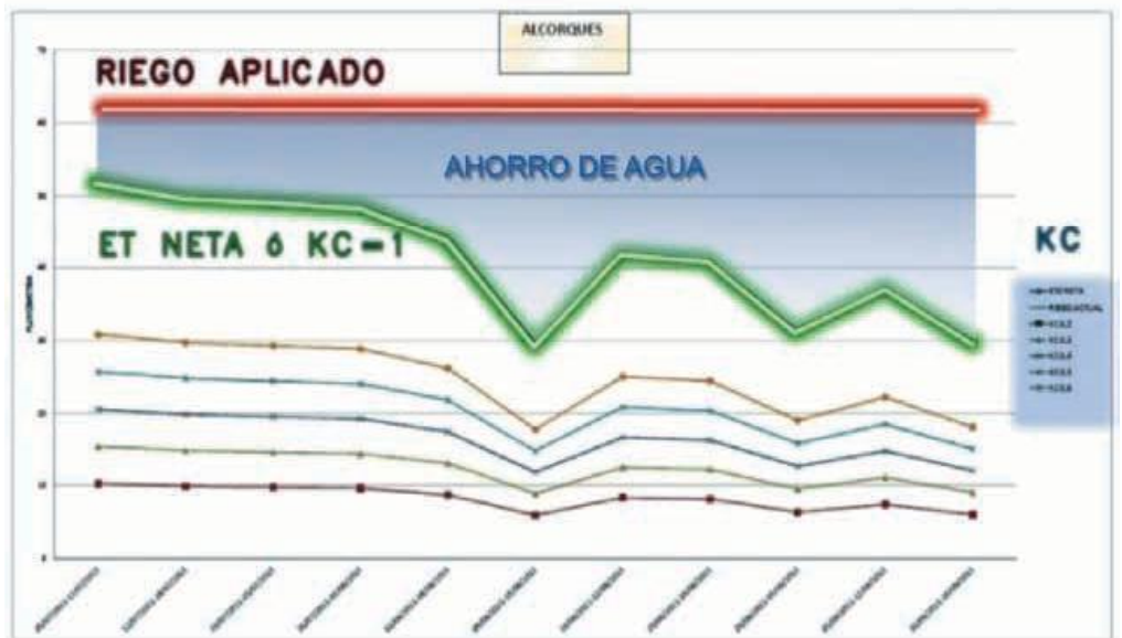
Gráfico 1. Riego por tiempos fijos Vs Riego por ET. Fuente: Audit Irrigation
