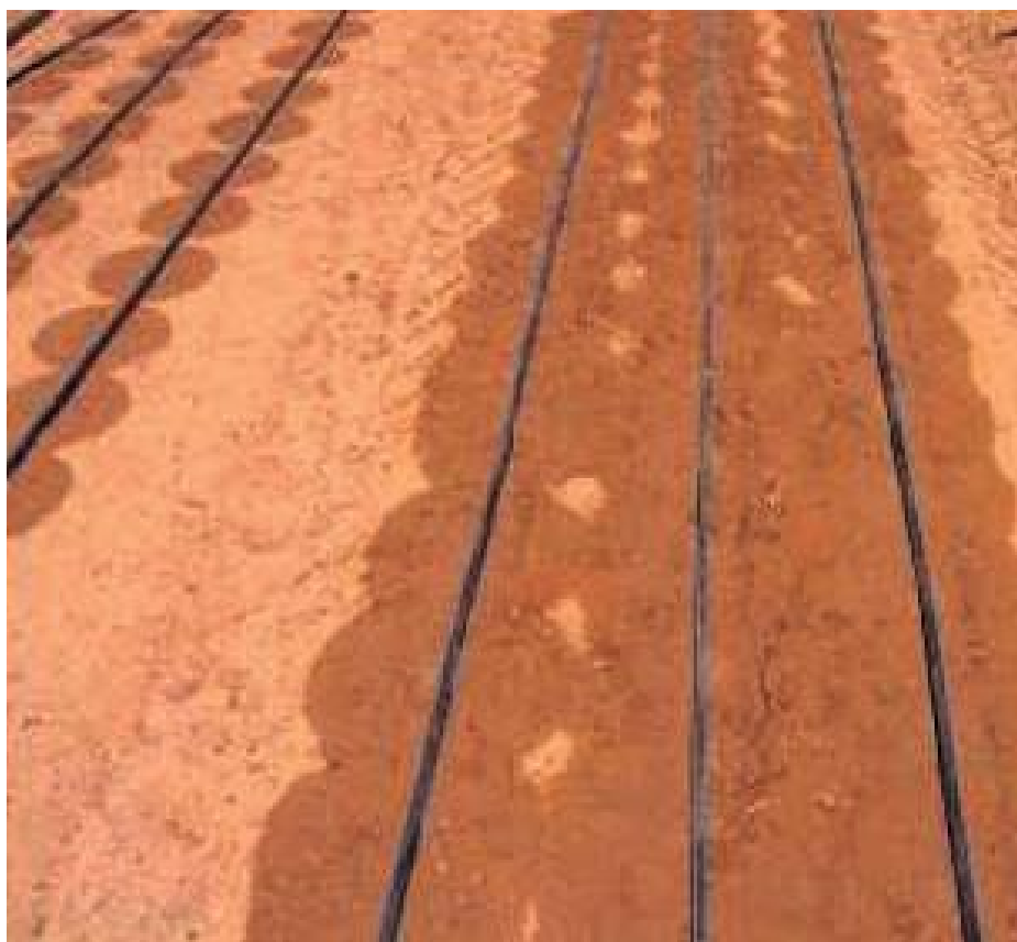
Figura 8. Diferencia de la distribución del agua con gotero de 2,3 l/h y gotero de 0,6 l/h. Fuente: Regaber
