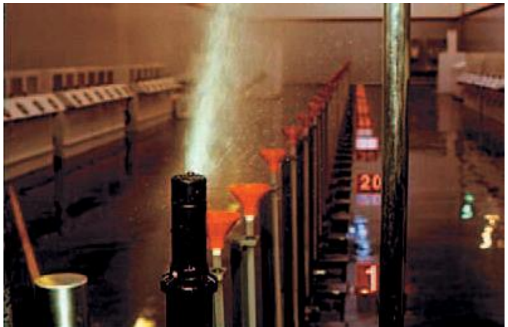
Foto 2. Ensayos en laboratorio de uniformidad de riego de un aspersor. Fuente: Hunter Industries
