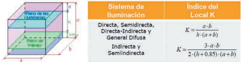
Figura A3.1. Ilustración y tablas explicativas del cálculo del índice del local.
