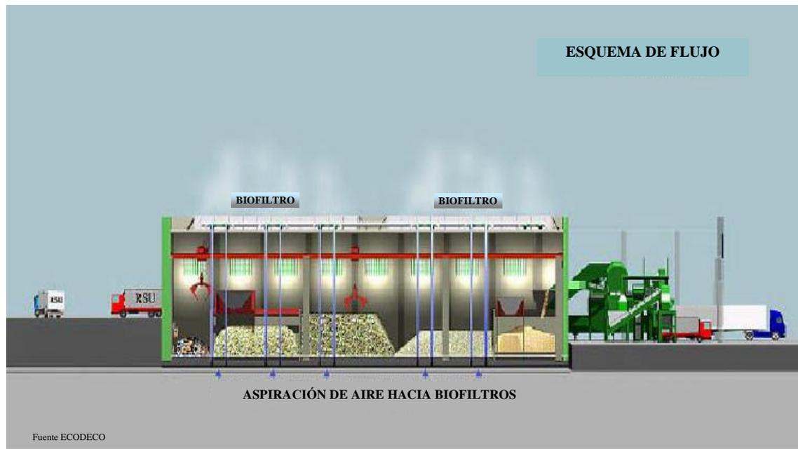
**Figura 5.** Esquema de flujo de una instalación de biosecado.
