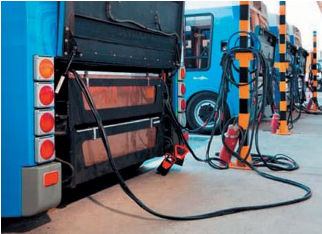
Figura 3.10. Recarga de un minibús eléctrico. Fuente: EMT, 2013.
