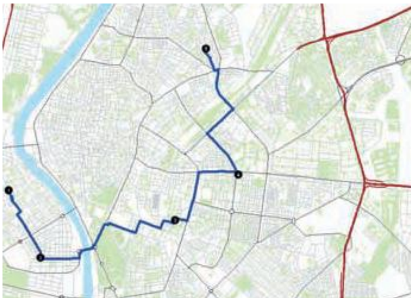
Figura 2.4. Resolución de un problema de Trazado de Ruta Óptima pasando por cinco puntos de control (salida, 3 puntos intermedios de parada y llegada) en una red urbana. Fuente: elaboración propia, 2013.
