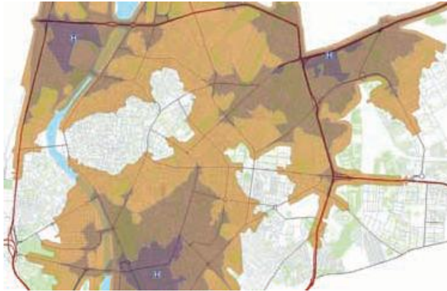
Figura 2.6. Resolución de un problema de Área de Servicio con tres posibles instalaciones de asistencia y tres rangos de tiempo de asistencia: áreas de servicio para tiempos de asistencia de 10, 20 y 30 minutos. Fuente: elaboración propia, 2013.
