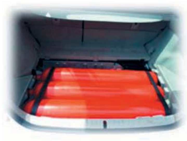
Figura 4.1. Depósitos de GNC en vehículo transformado. Fuente: Gas Natural, 2013.
