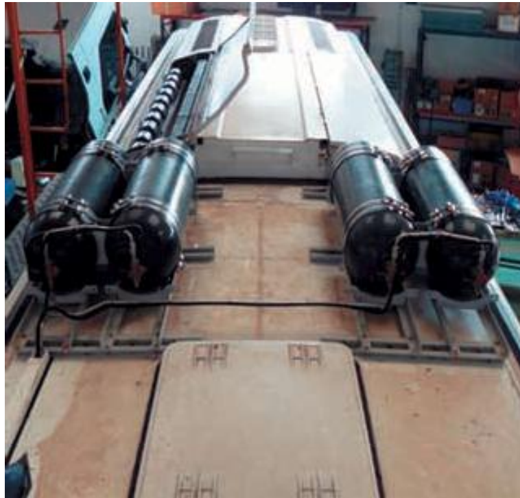
Figura 3.6. Depósitos de GNC en el techo del autobús. Fuente: EMT, 2013.
