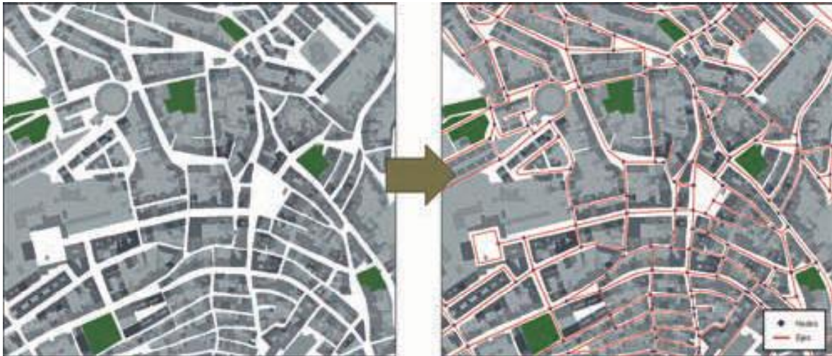
Figura 2.1. Modelización del entramado urbano de calles en una red de transporte con estructura geométrica de arcos y nodos.
