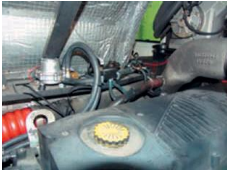
Figura 3.5. Reductor e inyectores de gas natural en el colector de admisión del motor diésel. Fuente: EMT-INMOTIA, 2013.
