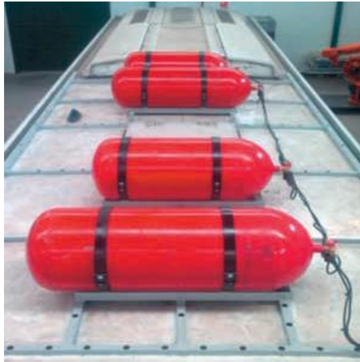
Figura 3.4. Depósito de GNC en el techo del autobús. Fuente: EMT, 2013.
