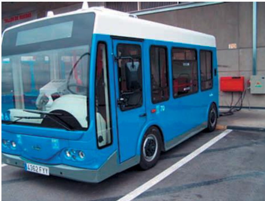
Figura 3.9. Punto de recarga de un minibús eléctrico. Fuente: EMT, 2013.
