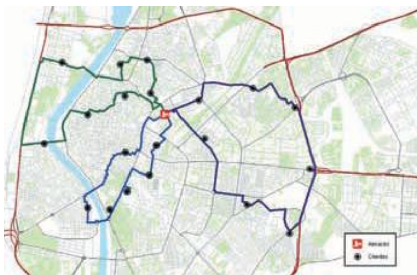
Figura 2.7. Resolución de un problema de Rutas para Flotas de vehículos de suministro desde un almacén a un total de 20 clientes.
