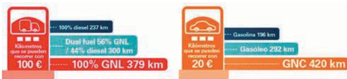
Figura 4.4. Esquema de kilómetros recorridos para el mismo gasto económico. Fuente: Gas Natural, 2013.
