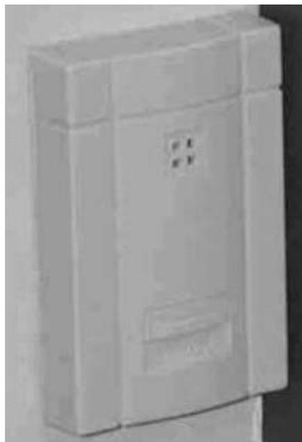
**Ilustración.** Lector de tarjetas de proximidad para control de acceso.
