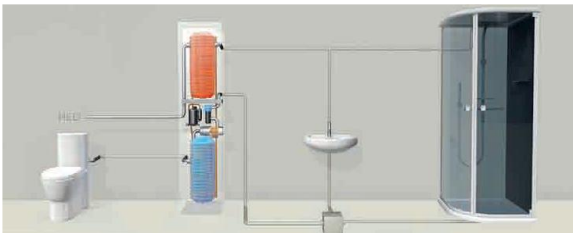
Figura 4a. Esquema de funcionamiento de un sistema de recuperación individual de energía de aguas grises. Fuente: Kalhidra.
