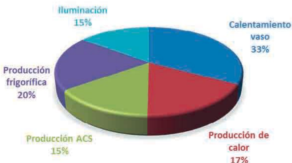
Figura 2. Balance energético en un Centro Deportivo tipo con piscina cubierta. Fuente: Endesa.
