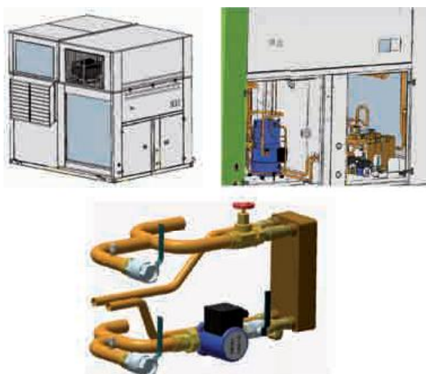
Figura 2. Equipo de climatización aire-aire equipado con recuperación de calor de gases calientes. Fuente: CIAT.
