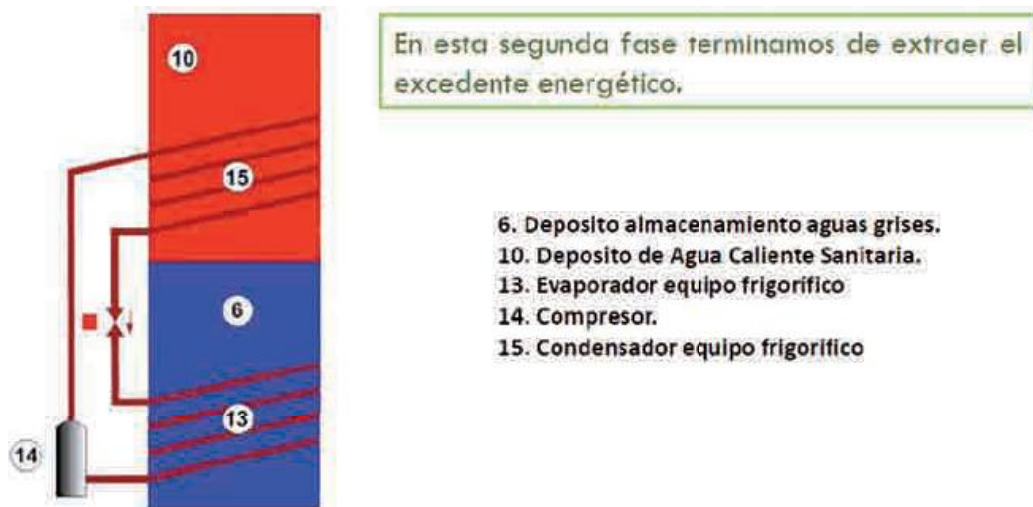
Figura 5b. Fase bomba de calor (energía hidrotérmica).
