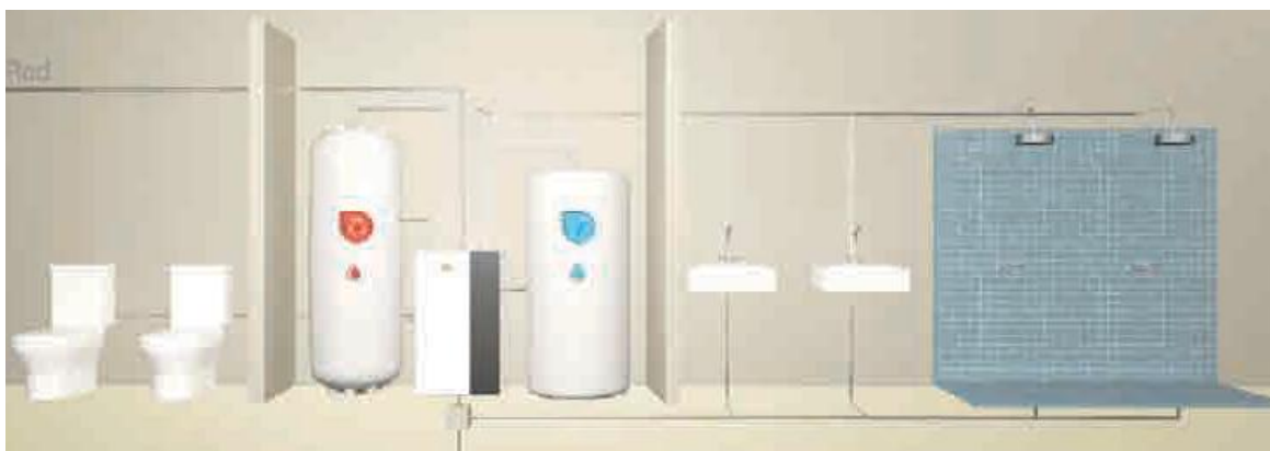
Figura 4b. Esquema de funcionamiento de un sistema de recuperación colectivo de energía de aguas grises. Fuente: Kalhidra.
