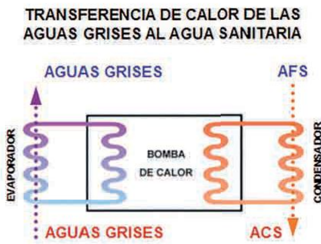
Figura 2. Bomba de calor agua/agua. Fuente: alter technica.
