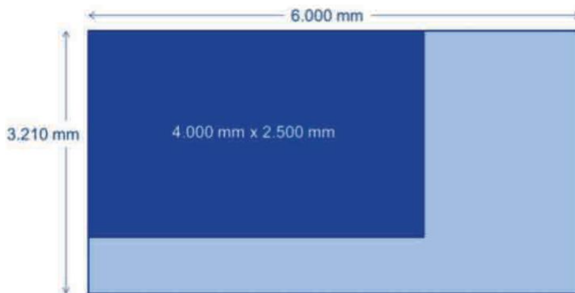
Figura 7.1 Explotación de una hoja de vidrio cuando uno de los lados supera los 3.210 mm. El lado corto no podrá superar esta medida.
