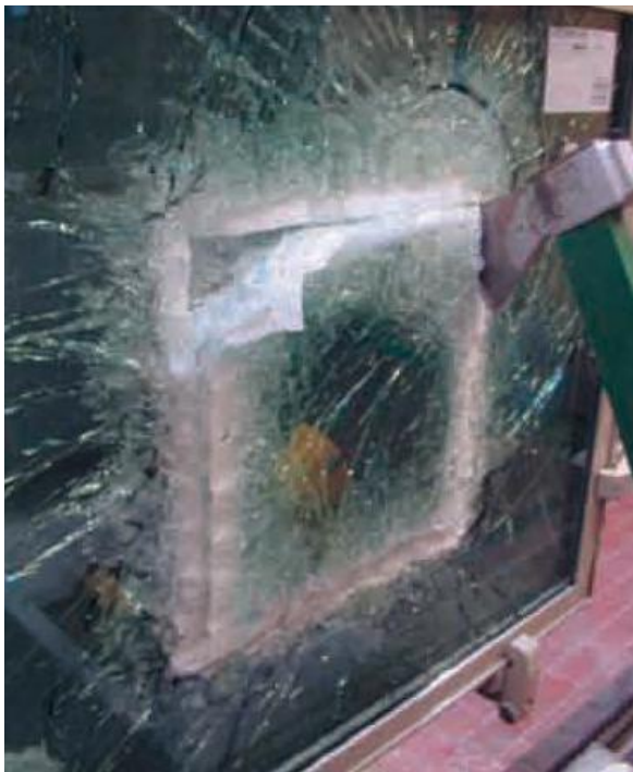
Foto 7.11. Ensayo del hacha UNE-EN 356 (III).
