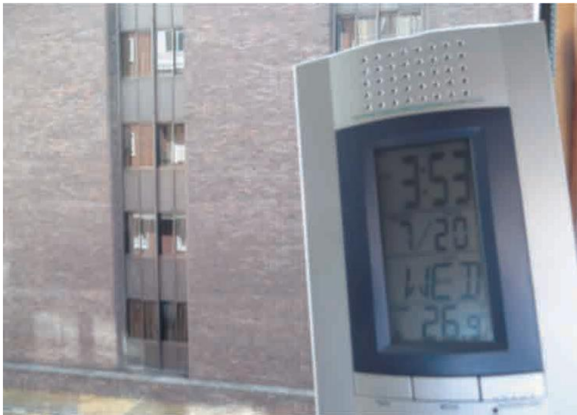
Foto 7.21. Temperatura en un local con sgg CLIMALIT PLUS con vidrios de ATR con protección solar ( g=0,42 ). T interior 26,9 °C – 20 de julio.
