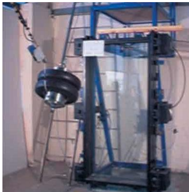
Foto 7.6. Ensayo del péndulo UNE-EN 12600. Fuente: Saint-Gobain Glass.
