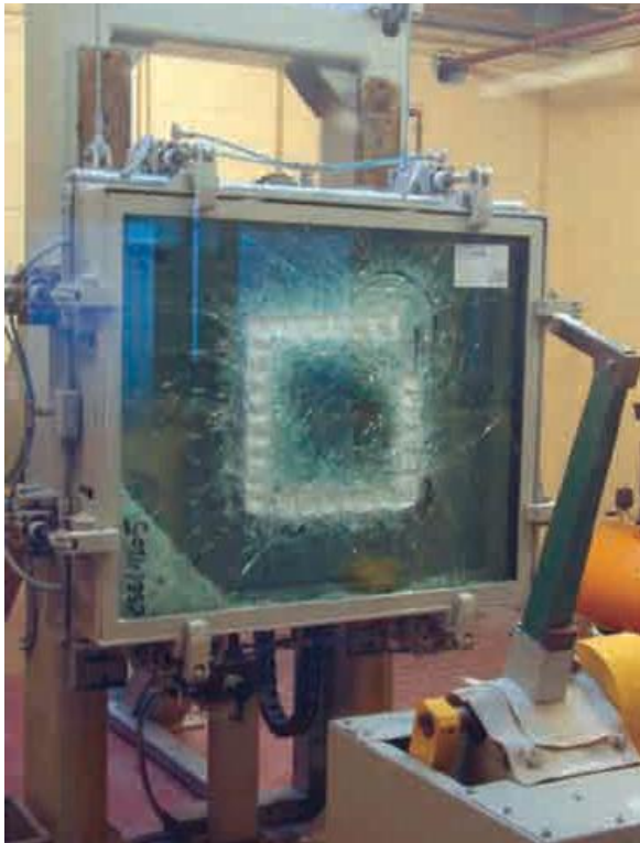
Foto 7.9. Ensayo del hacha UNE-EN 356 (I).
