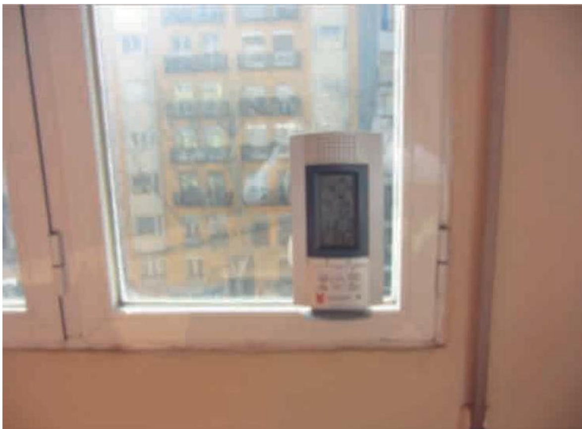
Foto 7.20. Temperatura en un local con acristalamiento UVA básico sin protección solar. T interior 33,2 °C – 20 de julio. Fuente: fotografía cedida por ANDIMAT.
