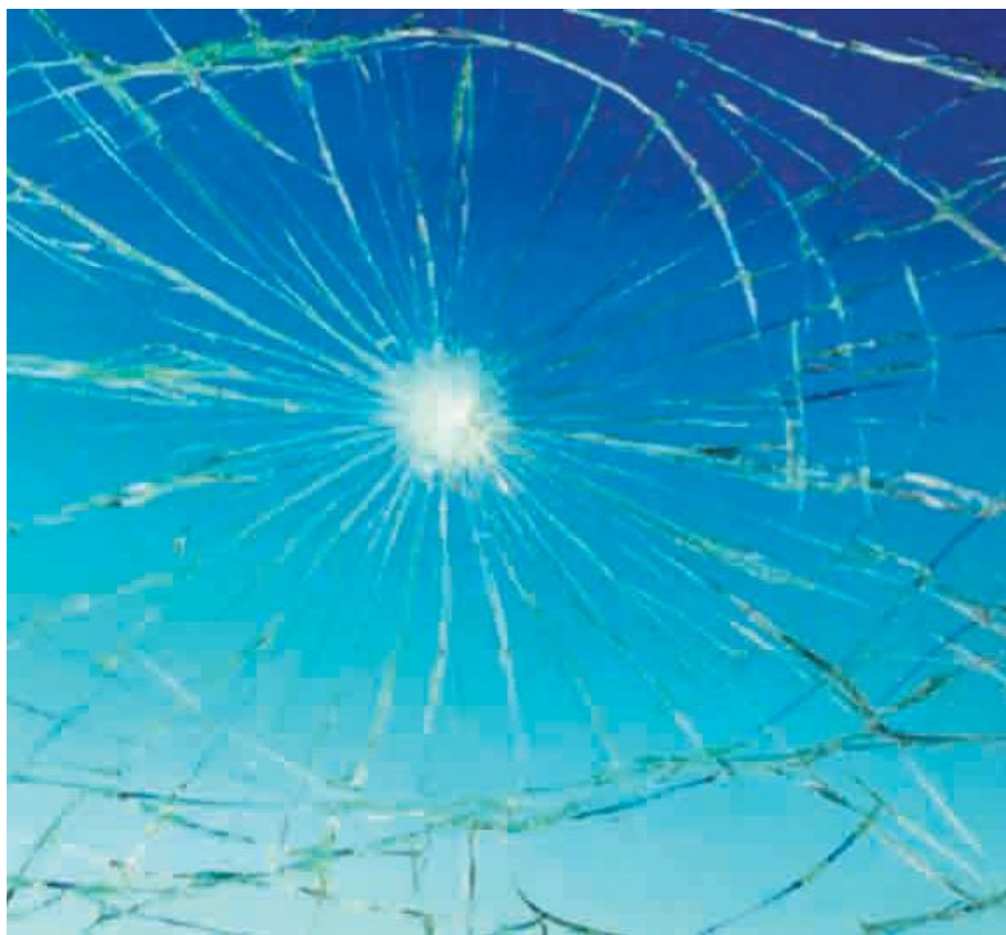
Foto 7.7. Impacto sobre vidrio laminado de seguridad.
