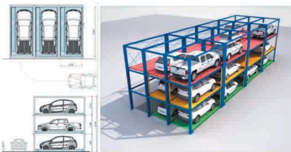
Figura 8.6. Esquemas y vista de un sistema semiautomático con apilamiento triple y salida individual de los vehículos. Configuración en 3 columnas y 4 filas.
