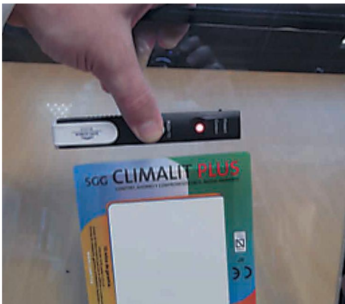
Foto 7.19. UVA de ATR con capa bajo emisiva inapreciable a la vista y detector de capa en funcionamiento.
