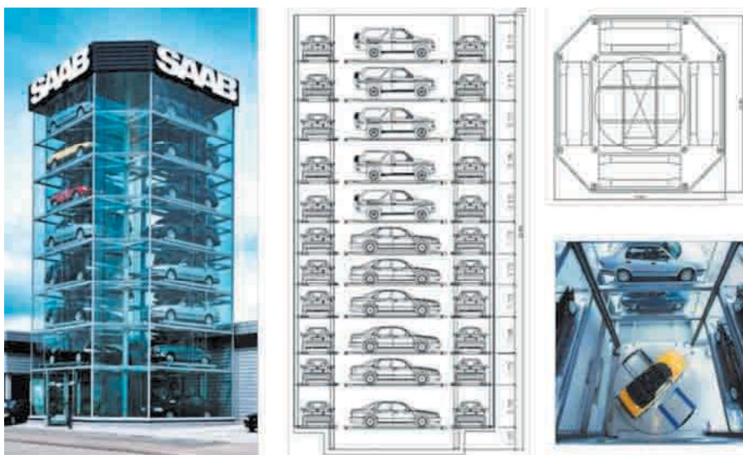
Figura 8.9. Secciones y vista de un sistema de torre vertical de estacionamiento y exposición de vehículos. Simplicidad, transparencia y visibilidad, rasgos que hacen de este tipo de instalaciones aptas para varios tipos simultáneos de uso de estacionamiento, mucho más que un almacén.
