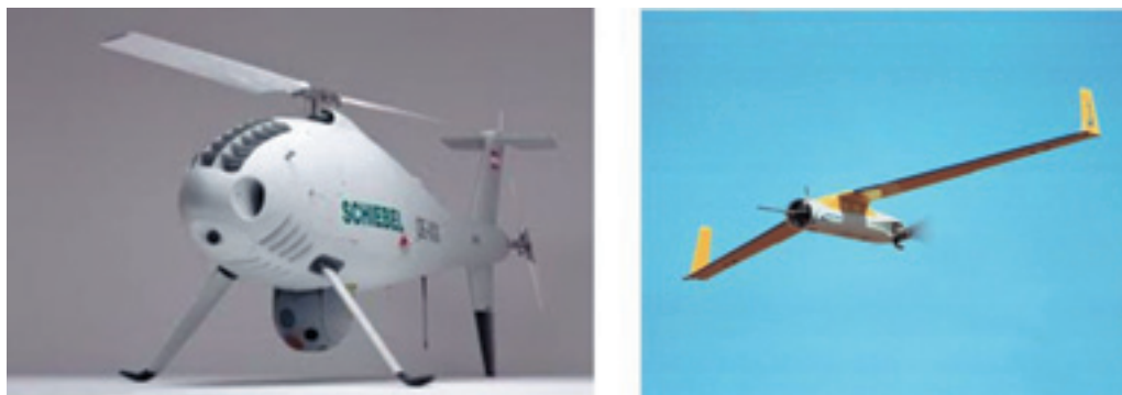
Figura 1.11. A la izquierda, el UAS VTOL Schiebel Camcopter S-100 y a la derecha el Scan Eagle de Boeing/InSitu.
