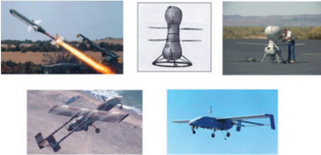
Figura 1.7. Sistemas no tripulados más relevantes en la década de los 80. De izquierda a derecha y de arriba a abajo, el Canadair CL-89 y CL-289 , el Canadair CL 227 y CL 327 , el IAI Scout y el IAI Pioneer .
