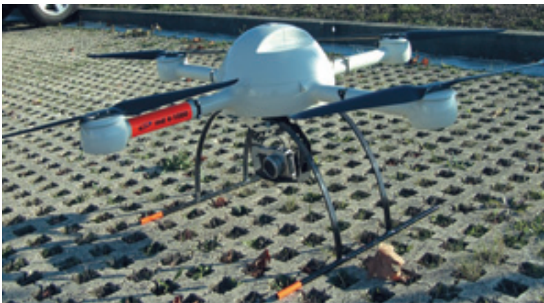
Figura 11.2. Plataforma empleada (Md4-1000) con cámara fotográfica RGB.
