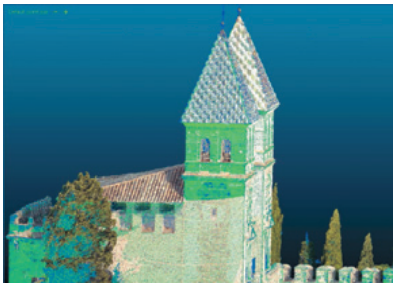
Figura 12.10. Fusión de datos láser escáner (intensidad) y nube de puntos UAV (RGB) con un error menor a 2 cm en la alineación.
