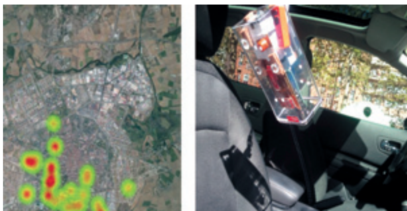
Figura 4.6. Ejemplo de los resultados de medida llevada a cabo mediante el dispositivo móvil desarrollado por Airstudio y la Universidad del País Vasco para la medida geolocalizada de la contaminación de CO. A la izquierda los niveles relativos de medida de contaminación y a la derecha el dispositivo de medida colocado en el vehículo.
