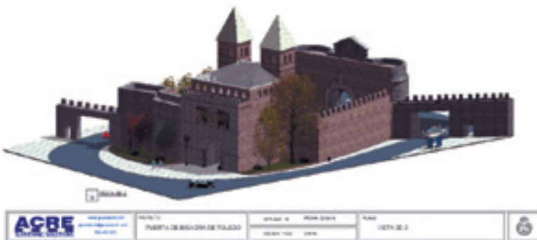
Figura 12.11. Modelo Revit de La Puerta de Bisagra (Toledo) elaborado a partir de nube de puntos obtenida mediante UAV.
