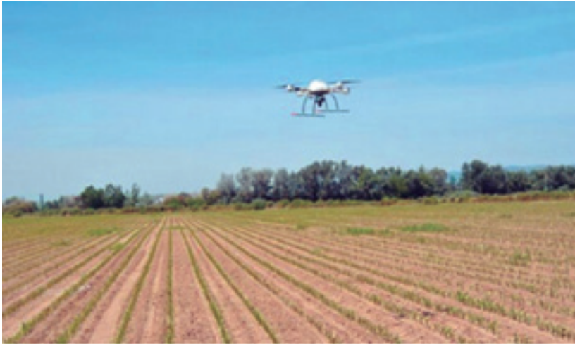
Figura 8.4. SARP equipado con sensor multiespectral volando una parcela de maíz infestada de rodales de malas hierbas en época temprana (López-Granados, 2013).
