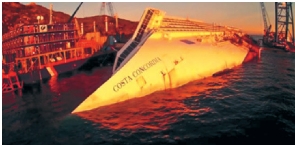
Figura 16.4. La utilización de drones permitió lograr esta imagen del comienzo de los trabajos de reflotación del crucero «Costa Concordia».
