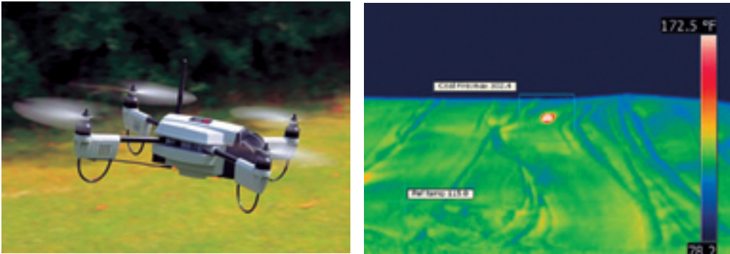
Figura 6.11. Aeronave con cámara termográfica e imagen de infrarrojos captada en un acopio de carbón con una zona en autocombustión (FLIR).
