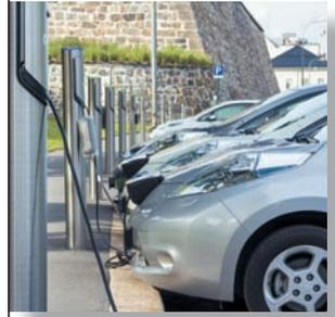
Figura 4. Vehículos eléctricos cargando en modo 1 y 2 con toma schuko.
