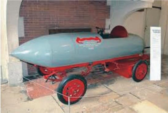
**Figura 2.** La «*Jamais contente*», el primer vehículo eléctrico capaz de superar los 100 km/h, se puede visitar en el museo de la automoción de Compiègne, en Francia.
