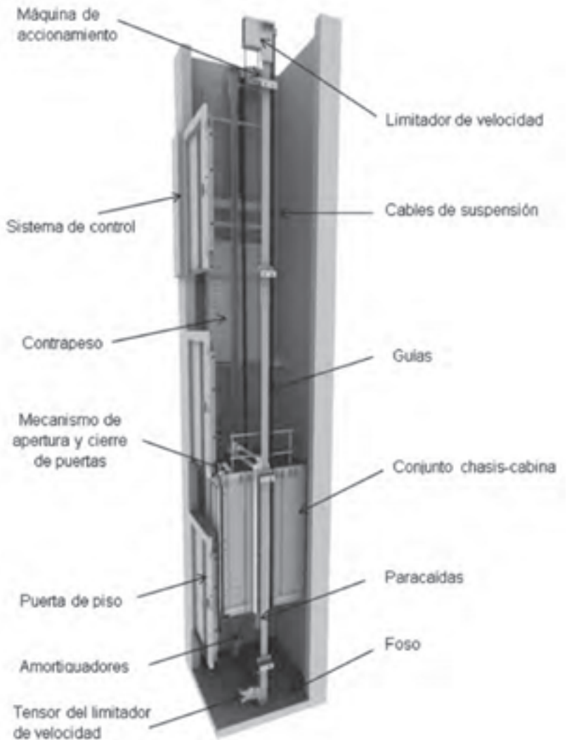
Figura 2. Instalación de un ascensor eléctrico. Fuente: Orona.
