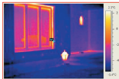
Figura 8.2. Salida de calor.
