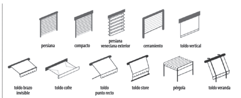
Figura 9.1. Ejemplos de sistemas de protección solar.
