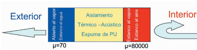
Figura 8.12. Modelo de sellado en 3 capas.
