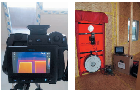
Foto 11.1 y 11.2. Imágenes de una cámara termográfica visualizando una ventana y un test de estanqueidad en desarrollo, ambos en obra nueva.
