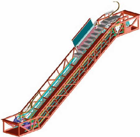
Figura 2.3. Estructura portante escalera mecánica. Fuente: ThyssenKrupp.
