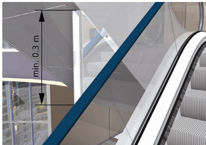
Figura 5.22. Instalación de deflector. Fuente: Schindler
