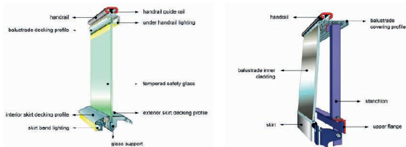
Figura 2.2. Balaustrada de cristal (iluminaciones) - Balaustrada Opaca.
