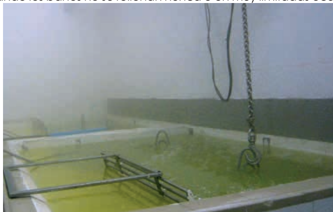
Foto 8.5. Baño industrial en una fábrica de quesos (40 °C).
