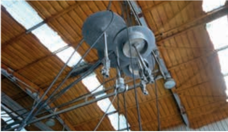
Foto 8.3. Sistema de lavado industrial de depósitos (59-60°C)
