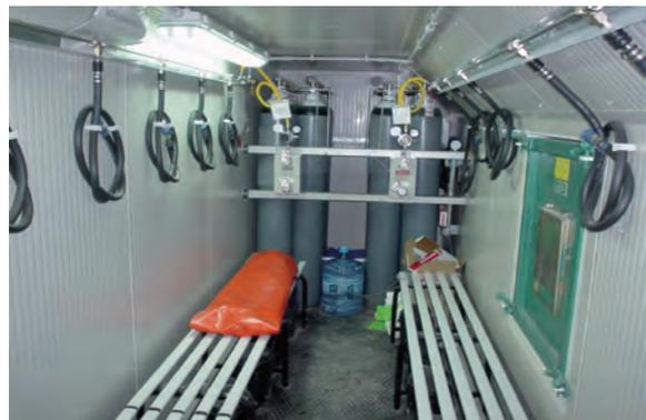
Cámara de rescate instalada en una tuneladora.
