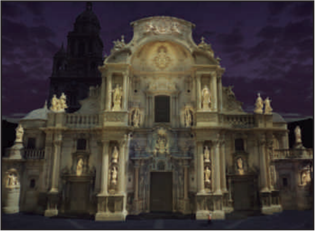
Infografía para el proyecto de la catedral de Murcia con un tratamiento de imagen excesivamente teatral que acentúa las diferencias de luminancias entre los distintos planos dando una idea de relieve superior a la real.
