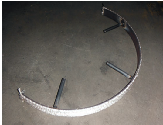
Figura 4.3.1.A. Ejemplo de distanciador para tubería horizontal.
