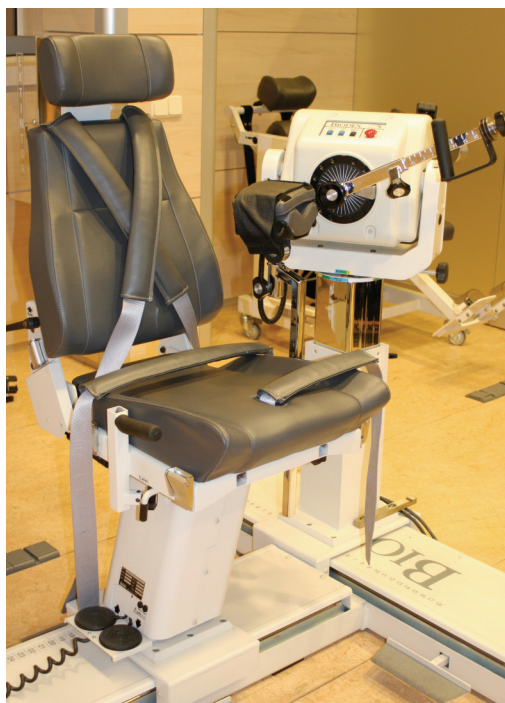
Figura 2. Cabezal de dinamómetro y sillón con sistema de correas
