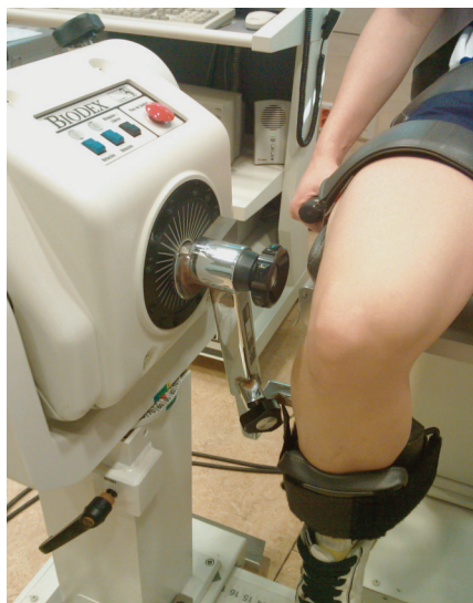
Figura 5. Estabilización mediante correas y alineación del eje de la rodilla con el eje del dinamómetro tomando como referencia ósea el epicóndilo externo femoral.
