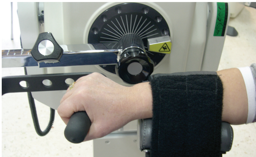
Figura 4. Estabilización mediante correas y alineación del eje de la muñeca con el eje del dinamómetro tomando como referencia ósea la apófisis estiloides cubital.
