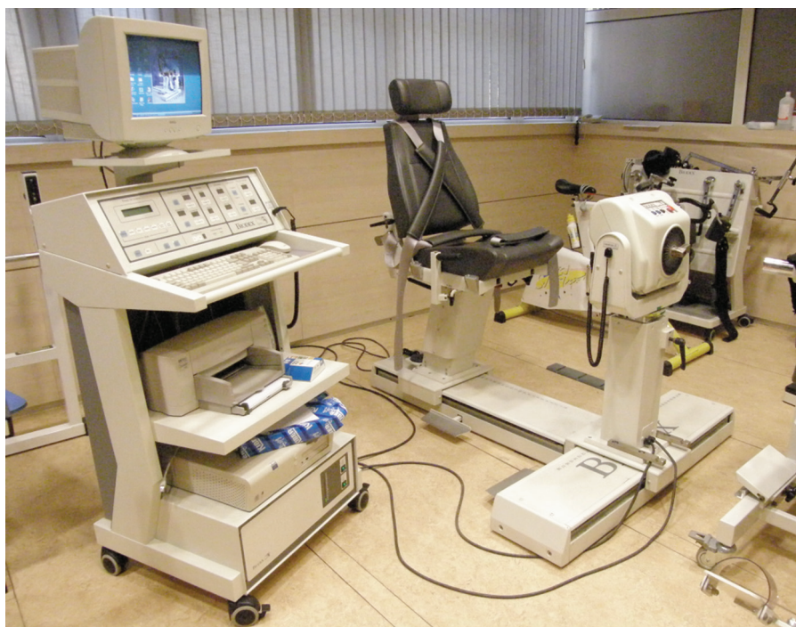
Figura 1. Composición general de un equipo isocinético
