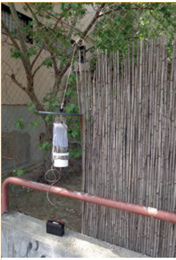
Figuras 15 y 16. Actuaciones de control del vector. Instalación de trampas de luz.
