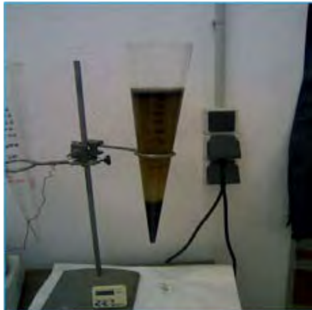
Figura 29. Pruebas para la determinación de los sólidos sedimentables y flotantes, por cono Imhoff
