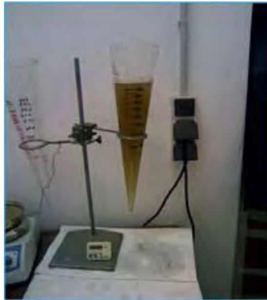
Figura 41. Apariencia del líquido sobrenadante después de la decantación a TRH de 2,5 horas
