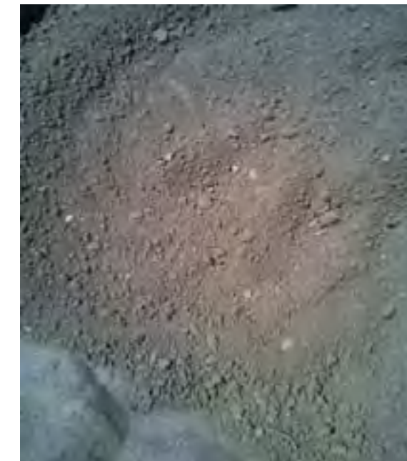
Figura 64. Precipitado seco del lecho fluidizado para un caudal de 1200 l/h sin recirculación
