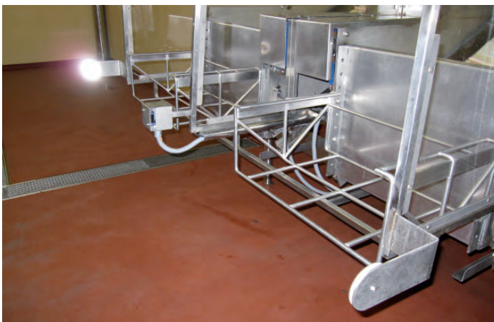
Volteador de cajas con células fotoeléctricas. Bodega Valquejigoso (Villamanta)
