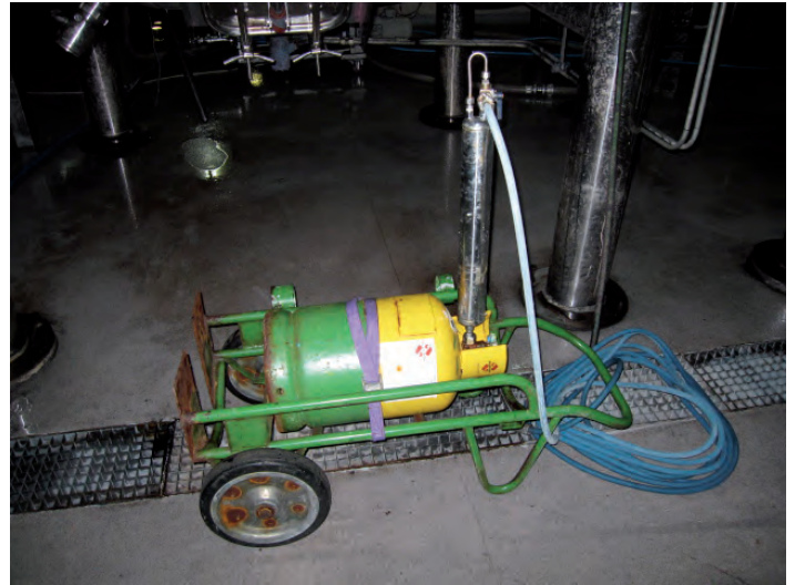
Carro de aplicación de sulfuroso con sulfitómetro.
