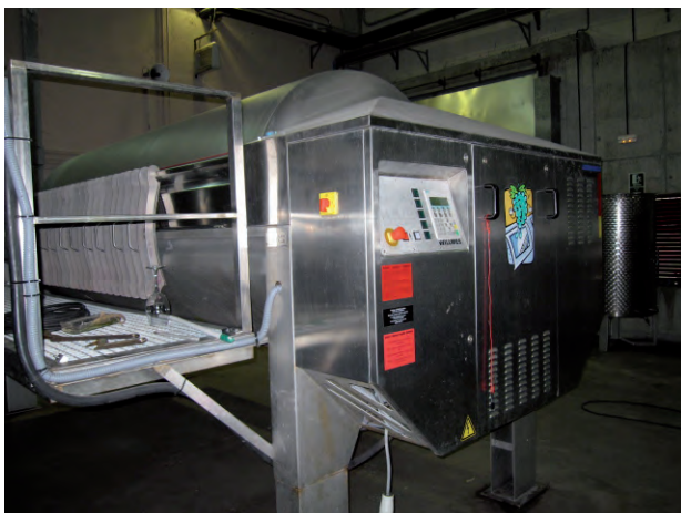
Prensa neumática con plataforma de seguridad. Bodega Tagonius (Tielmes)
