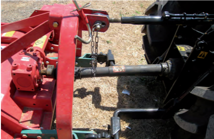
Protección de la toma de fuerza en el tractor.
