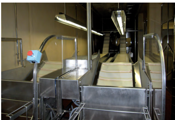
Cinta transportadora de selección de grano. Bodega Valquejoso (Villamanta)
