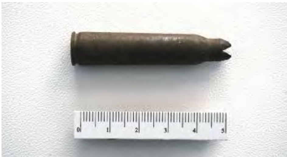
Fig. 4.- Vaina, tipo 1, para cartucho de salva de calibre 7,92 mm. Latón 72/28. Fabricada en 1921.
