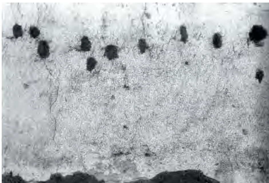
Figs. 4 y 5.- Visión normal de una sección de la pared y visión infrarroja B/N de la misma, para discriminar los diferentes tipos de pinturas.
