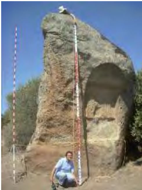
Fig. 1.- Malla de muestreo y medida de propagación de ultrasonidos.
