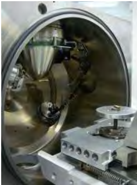
Fig. 1.- Cámara del Microscopio de Barrido SEM, con la muestra de estudio (Foto: A. Jorge).
