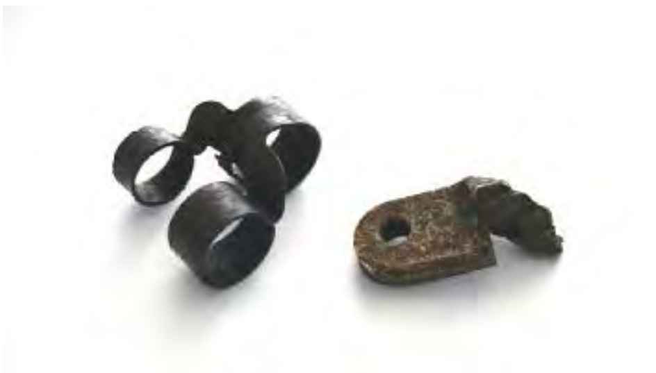
Fig. 7.- Piezas diversas, de izquierda a derecha: Tipo 4: Eslabón de cinta de alimentación del cartucho calibre 12,70 mm para ametralladora del mismo calibre. Anchura máxima de la cinta: 37 mm. Tipo 6: Pieza de posible elemento de acoplamiento de bípode de lanzagranadas de 88,9 mm.
