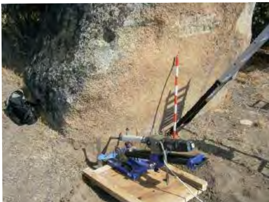
Fig. 12-13.- Toma de muestras para la caracterización del granito del monolito de Piedra Escrita.
