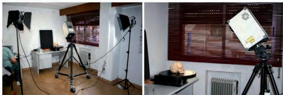
Fig. 3. Láser escáner, ordenador, focos y superficie de captura de imágenes.
