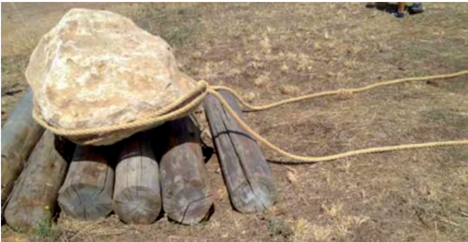
Fig. 6.- Sistema de transporte de piedras de gran tamaño en el Parque Arqueológico de Roa de Duero.
