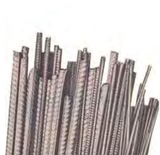
Armadura. Barra de ferralla corrugada
