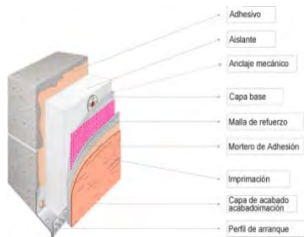
Esquema fachada SATE
