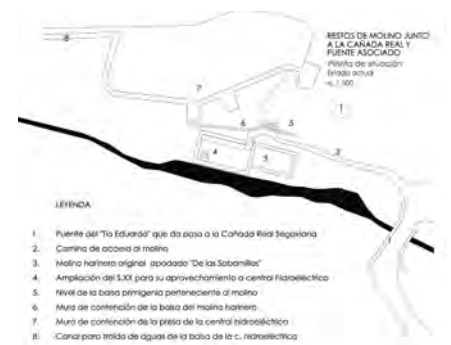
Planta, estado actual del molino junto a la Cañada y su puente asociado. En la imagen se puede observar el aumento de tamaño que sufrió la balsa original del molino para convertirse en la presa de agua de la central hidroeléctrica en la que se acabó convirtiendo.
