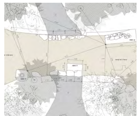
Croquis en planta donde se describe la situación previa a la intervención del tablero; se aprecia la presencia de piezas del pretil.
