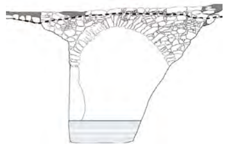
Esquema del posible nivel y perfil de la superficie de rodadura original.
