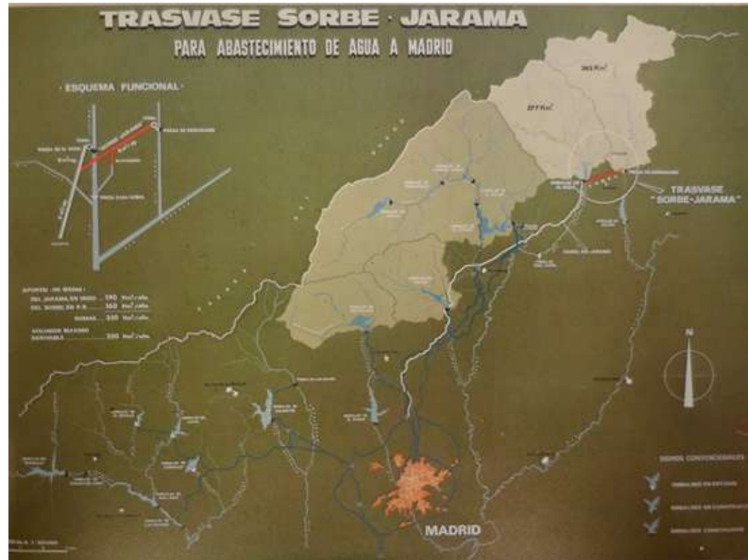
Figura 6.7. Agromán. Esquema general del trasvase Sorbe-Jarama. 1973
