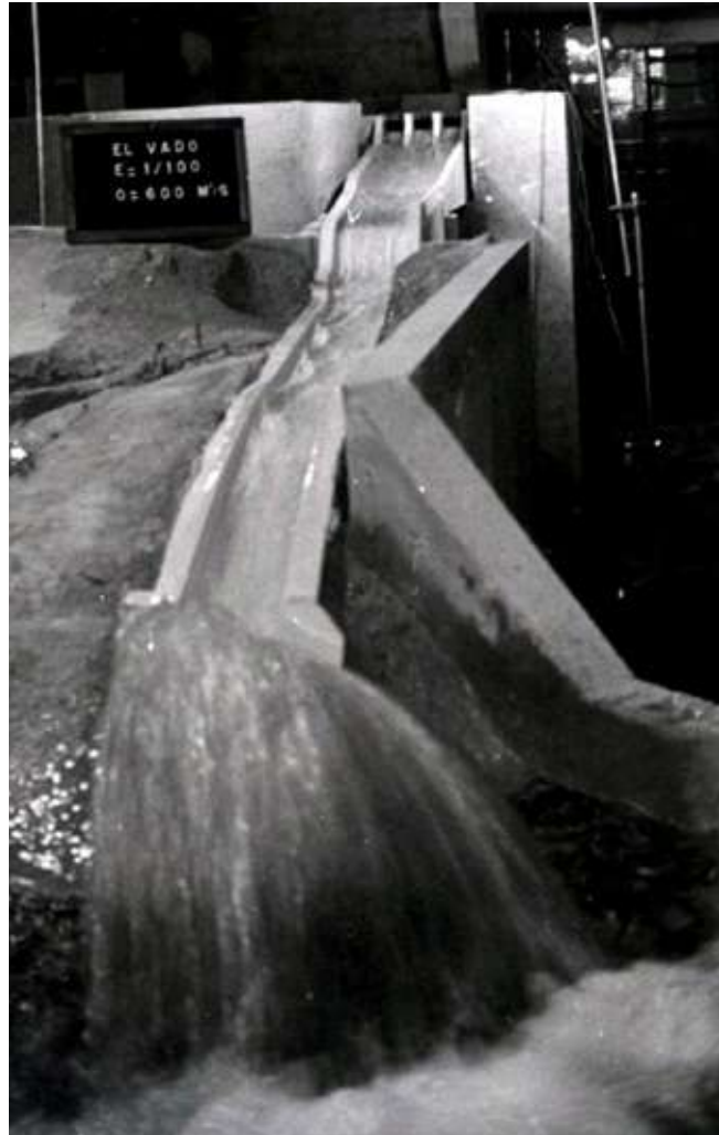
Figuras 4.127 a 4.129. Resultados de los ensayos en modelos reducidos del aliviadero del pantano de El Vado. Anejo nº 5 al proyecto de obras complementarias al aliviadero del embalse de "EL VADO". Año 1962. Fotografías de los ensayos
