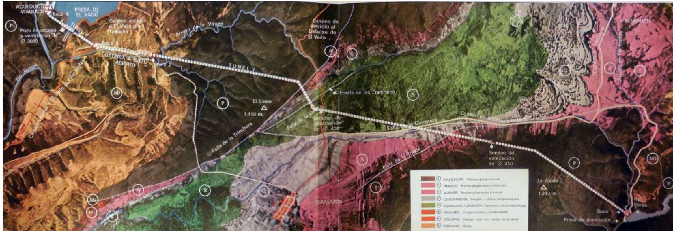
Figura 6.24. Planta general y geología superficial trasvase Sorbe-Jarama. Agromán. 1973
