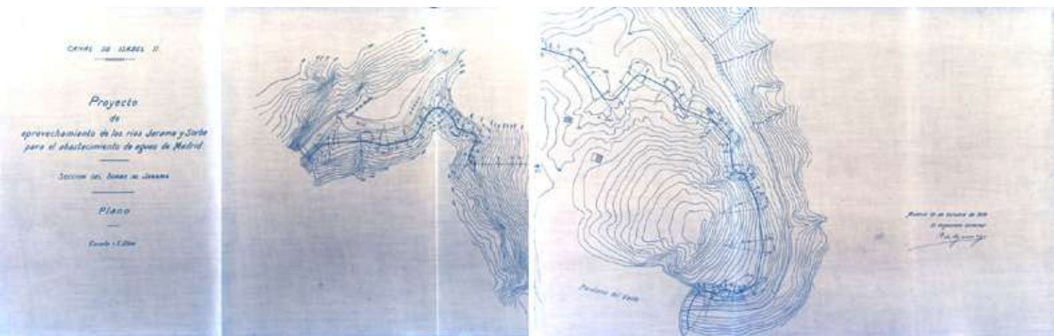
Figura 6.2. Plano del trazado del trasvase Sorbe-Jarama en el proyecto de Aguinaga, 1918. E 1:2500 Detalles del inicio y final del canal
