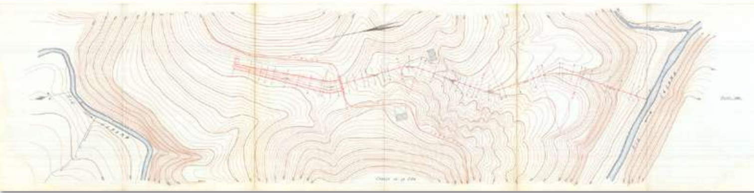
Figura 4.10. Plano, hoja 7. Disposición general del aliviadero de superficie y canal de desagüe. Pantano de El Vado: Proyecto. 1910
