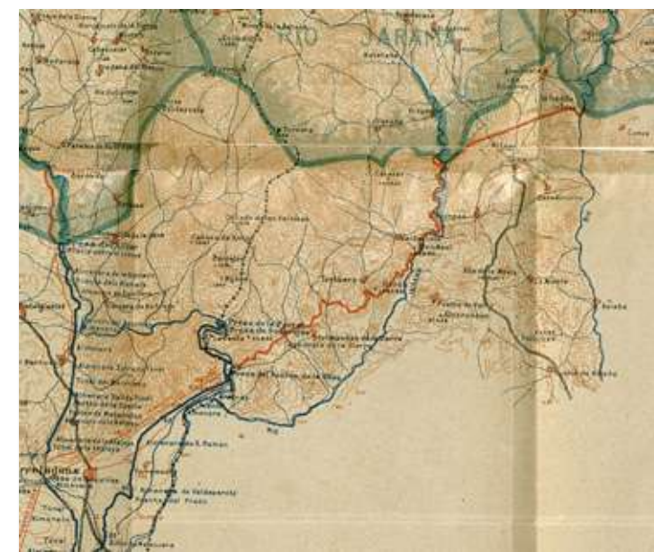
Figura 5.7. Detalle de la conducción desde el Sorbe y el Jarama hasta el Pontón de la Oliva, en el Lozoya. Incluido en la Memoria... del Canal de Isabel II, 1914, Madrid, 1915
