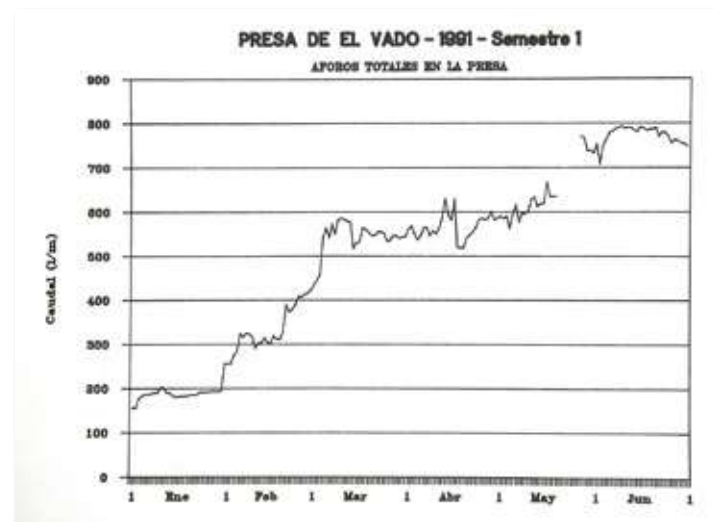
Figura 4.179 Aforos totales de galerías y drenes de la presa de El Vado, primer semestre de 1991
