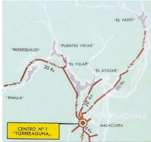
Figuras 5.31. Esquema del tendido de alta tensión desde Torrelaguna
