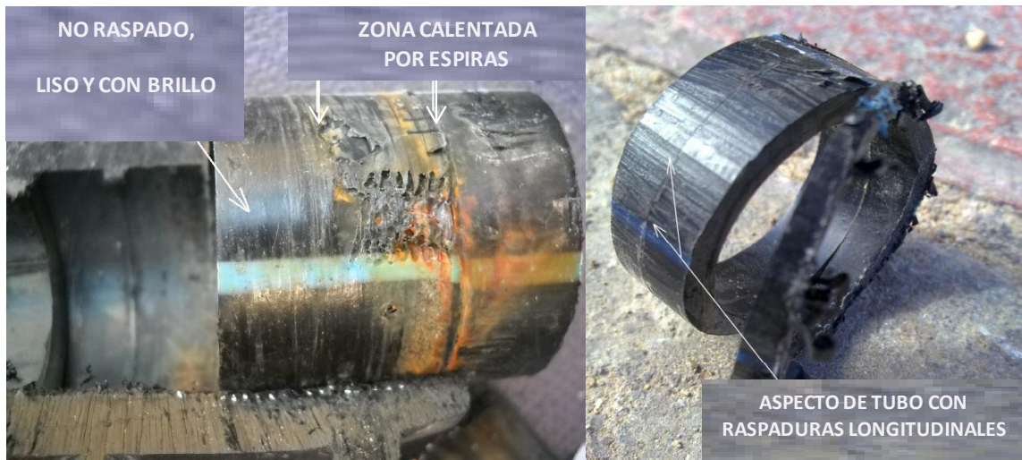
FIGURA 69. INCIDENCIAS EN JUNTAS ELECTROSOLDABLES
