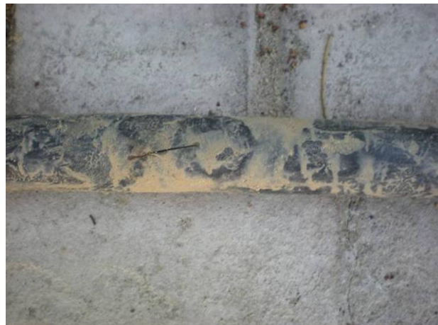
FIGURA 126. ROTURAS EN POLIETILENO FUERA DE NORMA, OCASIONADAS POR DEFECTOS DE INSTALACIÓN
