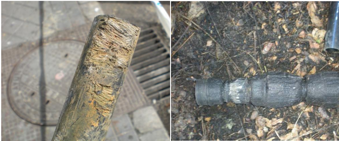
Tubería de polietileno no soterradas, dañadas por un incendio
