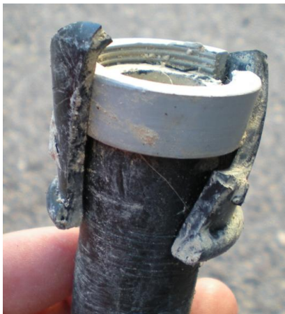
FIGURA 126. ROTURAS EN POLIETILENO FUERA DE NORMA, OCASIONADAS POR DEFECTOS DE INSTALACIÓN
