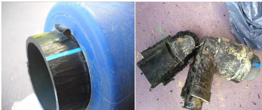
Rotura en la que el tubo no fue introducido en el acceso hasta la profundidad indicada por el fabricante
