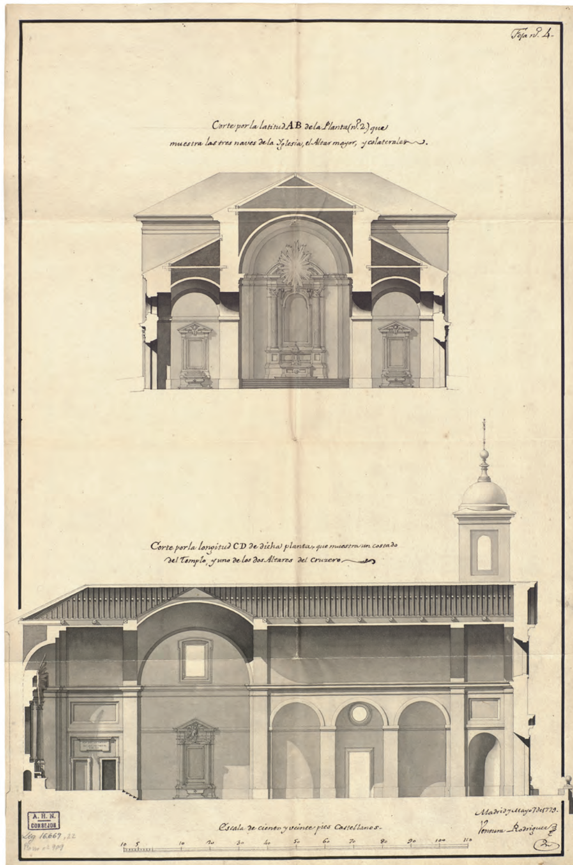
106.4. Iglesia parroquial de Santa María la Mayor, en Algarinejo: secciones transversal y longitudinal. A.H.N.
