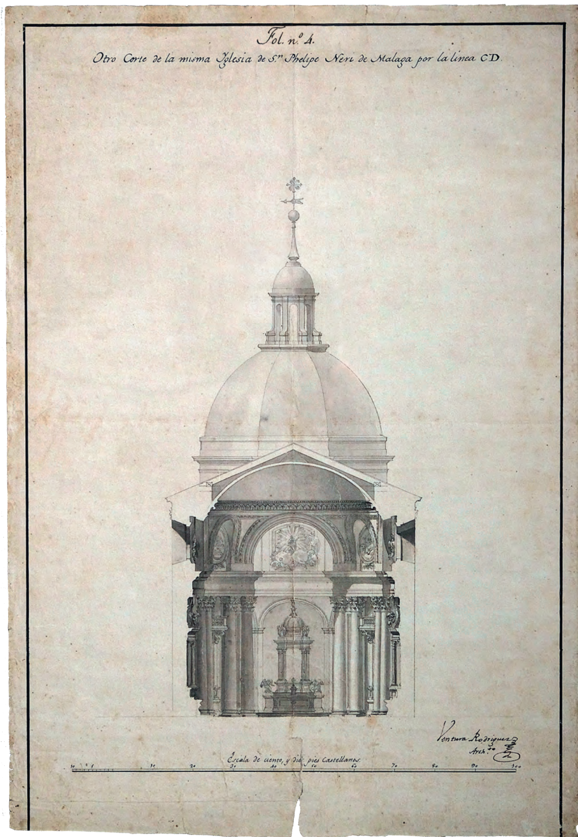
101.3. Iglesia de San Felipe Neri, en Málaga: sección transversal y alzado de la cúpula. C.P.F.M.
