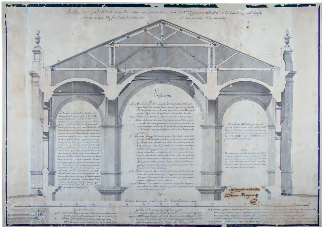
40.1. Catedral de Málaga: sección transversal de la cubierta propuesta. A.C.M.
