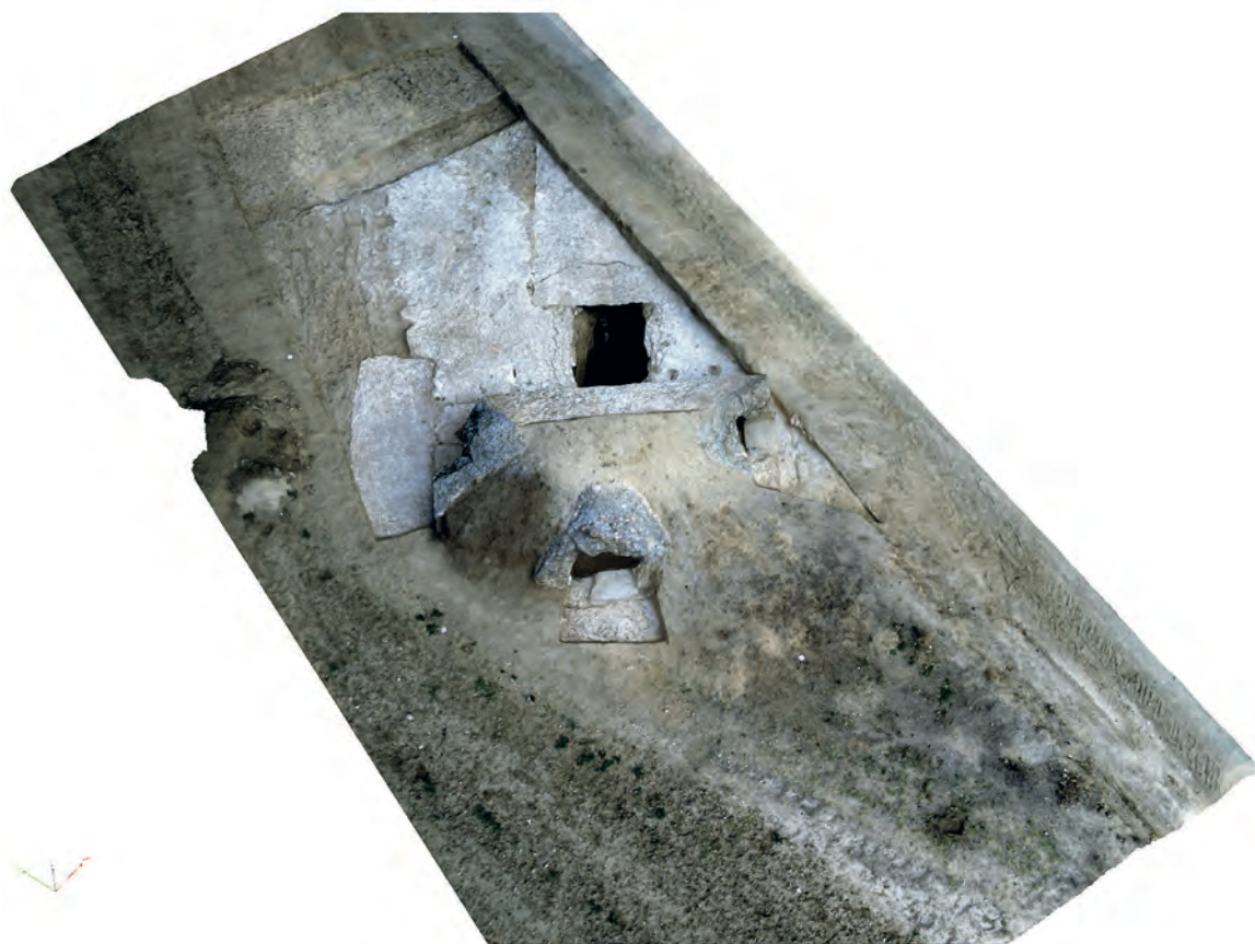
Fig. 5 Modelo tridimensional de un fortín en el Olivar de Veliso (Brunete) realizado mediante fotogrametría digital con imágenes tomadas desde un dron.
