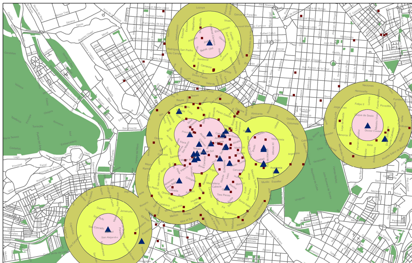
Figura 6 : Torres de refrigeración con recuento de Legionella superiores a 10.000 ufc/L y exposiciones (domicilio, trabajo, ocio) de los casos
