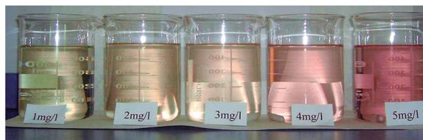
Imágenes representativas del ensayo de demanda de permanganato en una muestra de agua.
