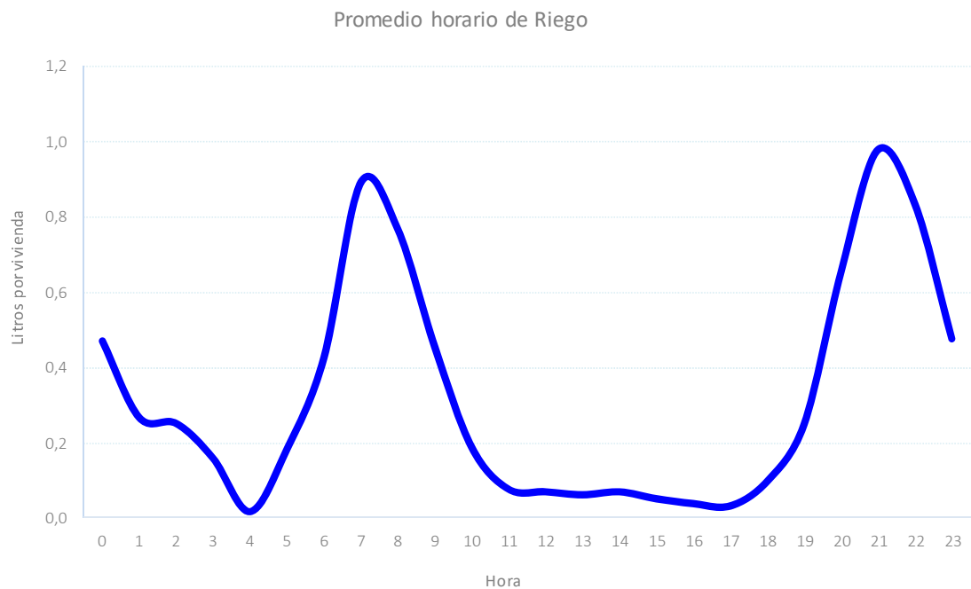
FIGURA 165. MODULACIÓN HORARIA DEL RIEGO
