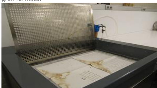
Reintegración de pulpa de papel en documentos de manera mecánica.
