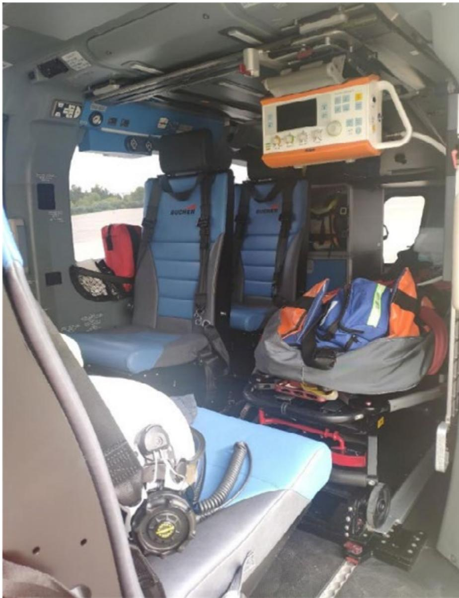
En el H145, disponemos del ventilador Oxylog 3000 plus<sup>®</sup>, que va anclado con un sistema de fijación, a un rail metálico deslizante, que permite ser desplazado con facilidad, tanto en sentido anteroposterior como lateral, a lo largo del techo de la aeronave.
