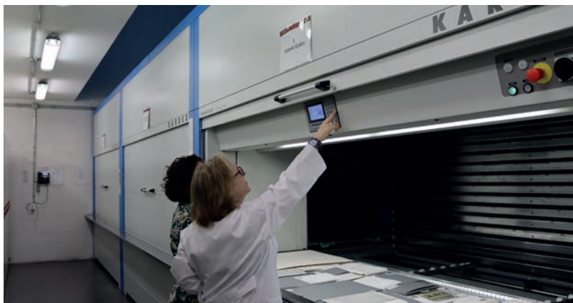
Sistema de almacenamiento mecánico.
