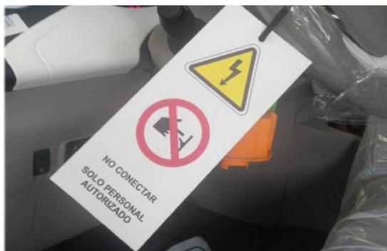
Figura 8. Colocación de tarjeta y conector de servicio en el volante. Fuente: imagen cedida por Feu Vert Ibérica, S.A.
