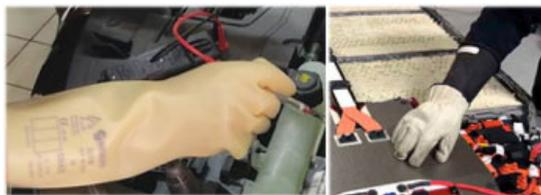
Figura 9. Guantes de protección eléctrica y mecánica
