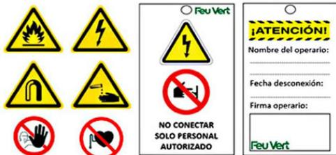
Figura 15. Señalización de advertencia y prohibiciones. Cartel identificativo del estado del vehículo.
