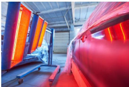
El proceso se realiza mediante equipos de secado infrarrojo que pueden ser manuales, móviles y de arco. El secador infrarrojo se constituye por una o varias pantallas cada una con un cuerpo reflector, una o varias lámparas y un soporte. El manual suele incorporar una sola lámpara y se debe sujetar por el operario. Los equipos móviles pueden disponer de una o varias pantallas montadas sobre un soporte móvil, con ruedas, e incluso con un sistema, brazos articulados,
