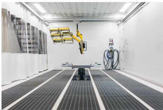
A esta zona de trabajo, que puede disponer de uno o varios puestos de trabajo o posición de vehículo, se le habilita con diferentes conexiones de aire comprimido (lubricado y seco), electricidad, aspiración de polvo, iluminación, paneles y cortinas separadoras entre puestos, equipos de secado (por infrarrojos, ultravioleta y sopladores), etc.
