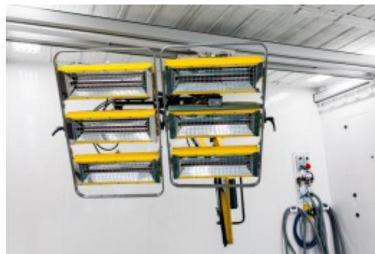
En lo relativo a las lámparas suelen ser de tipo cristal de cuarzo. Estos equipos incorporan un termómetro y un pirómetro para el control de la distancia y temperatura de la superficie a secar.
