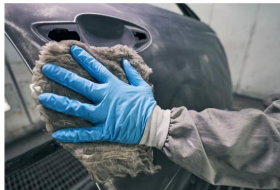
La operación se puede dividir en 3 pasos, soplado del vehículo, desengrasado y atrappolvo (que consiste en pasar un trapo especial impregnado en resina para finalizar la limpieza de la zona a pintar)
