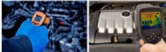
Figura 25. Termómetro y cámara infrarroja
