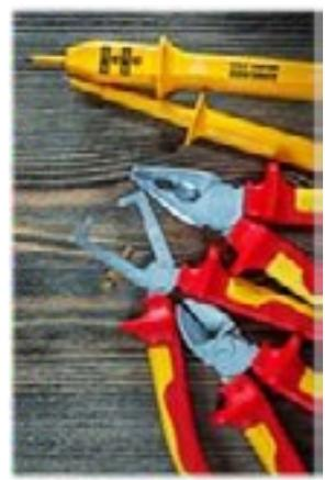
Figura 22. Herramientas manuales aisladas
