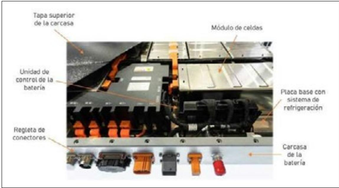
Figura 6. Vista por partes de una batería de Litio para un vehículo eléctrico
