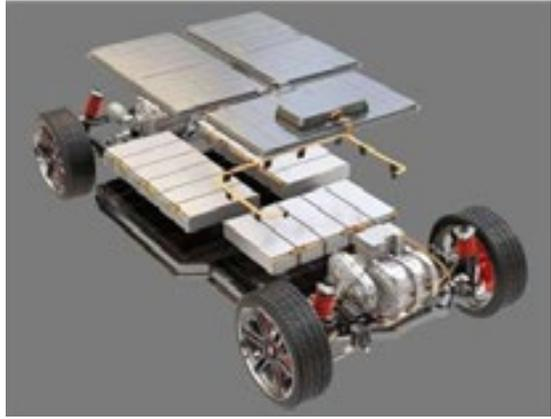
Figura 2. Chasis de un VE.
