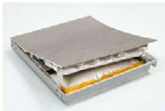
Figura 8. Batería de Litio dañada e hinchada.
