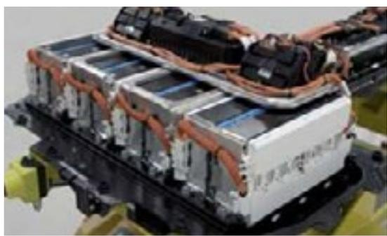
Figura 5. Batería de Litio para un vehículo eléctrico
