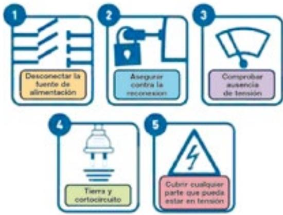
Figura 15. Las 5 Reglas de seguridad.
