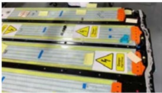
Figura 7. Señalización de peligro eléctrico en una batería de Litio.
