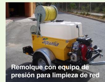
Remolque con equipo de presión para limpieza de red
