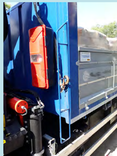
Acceso inadecuado para ascenso y descenso con carga completa
