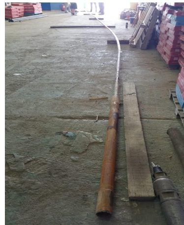
Figura 2: Sarta compuesta por batería, varilla de desagüe más seis varillas de 6 metros cada una.
