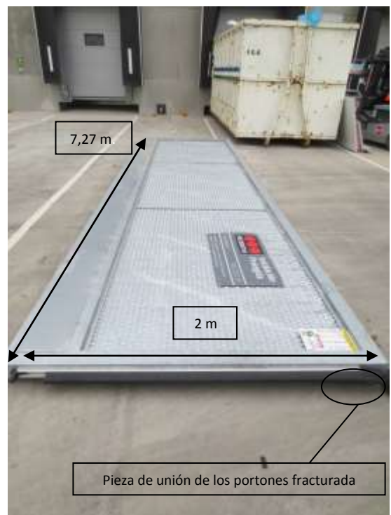
Figura 2: Detalle de la hoja del portón que se desplomó
