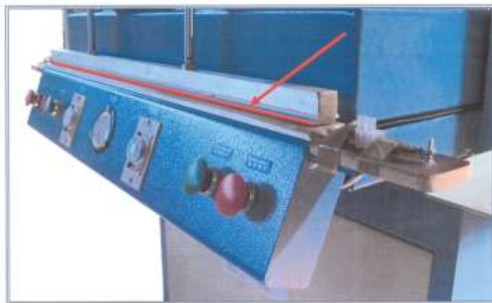
Figuras 1 y 2: Fotografía de la prensa real y detalle extraído del manual que indica la zona de atrapamiento
