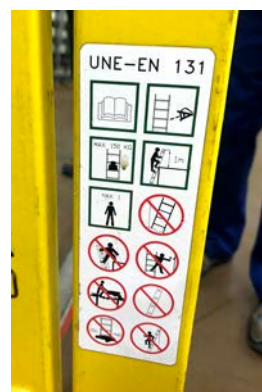
Figura 2: Señalización de advertencia en escalera
